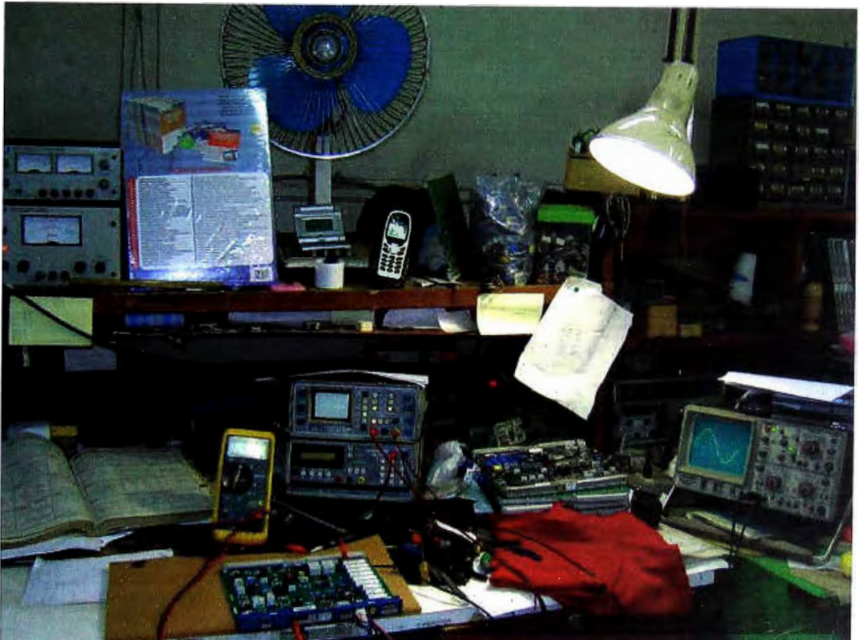
Fuente de alimentación continua, multímetro, osciloscopio y manuales
