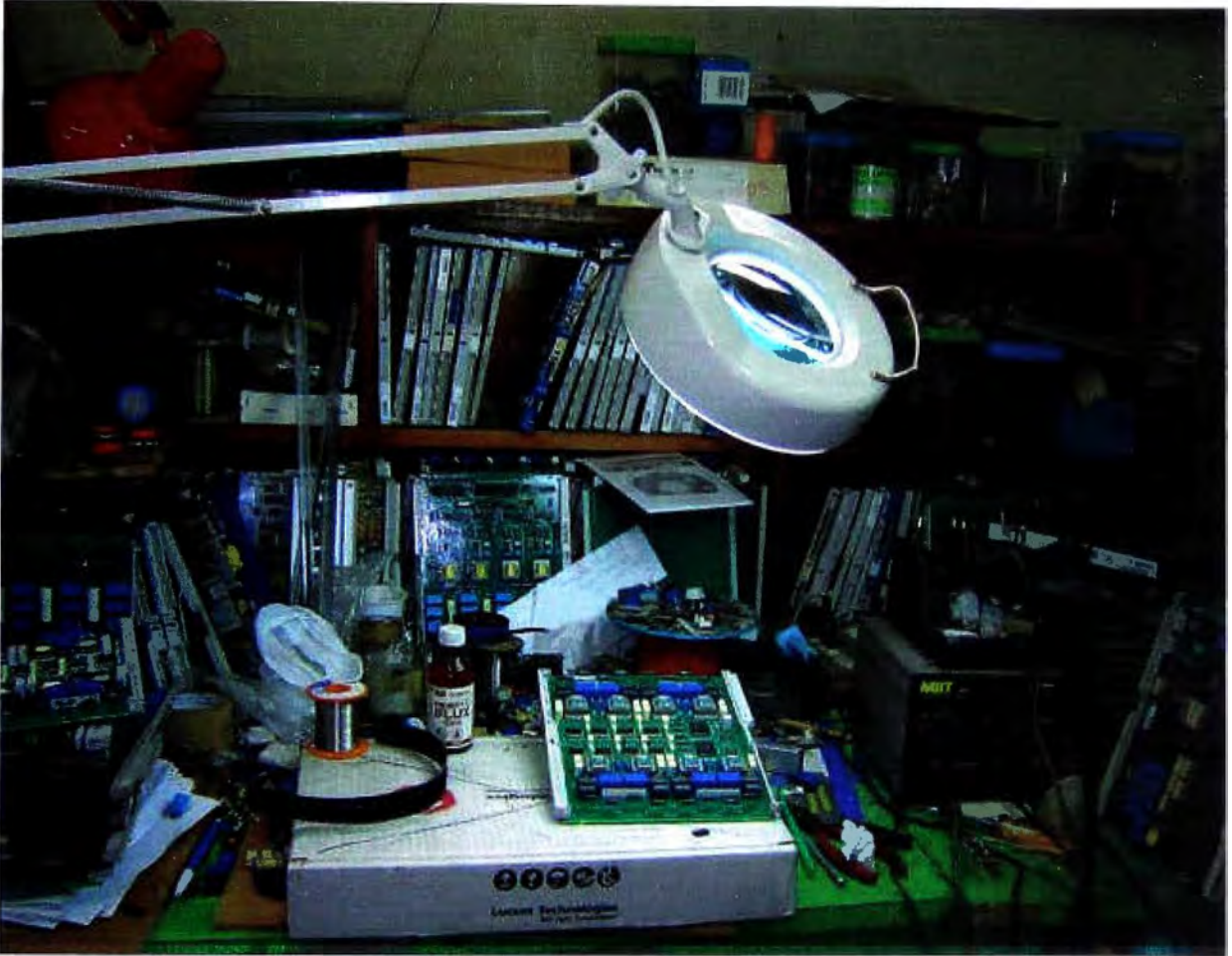
Equipo extractor de soldadura, lámpara con luna de aumento
