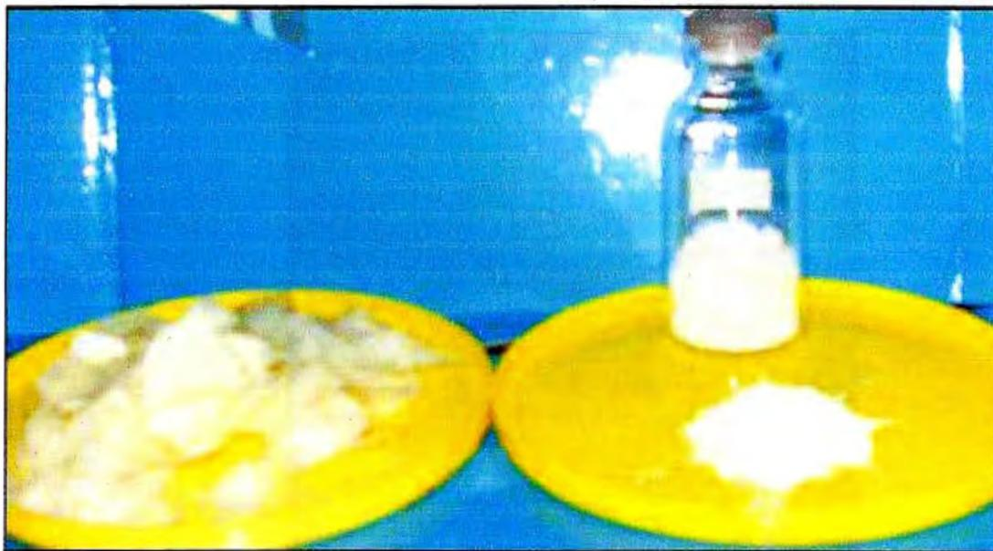
Fig. 13. Escamas de pescado y el adsorbente natural obtenido a partir de ella.
