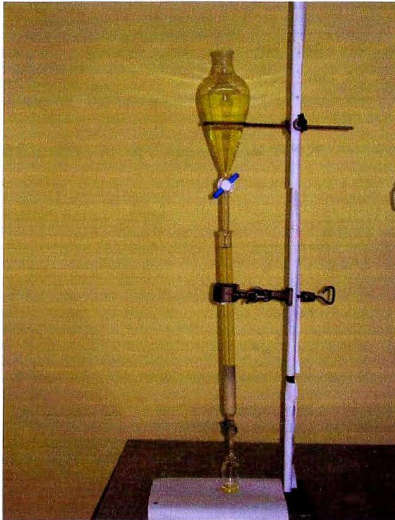
Fig. 60. Columna con empaque de adsorbente.
