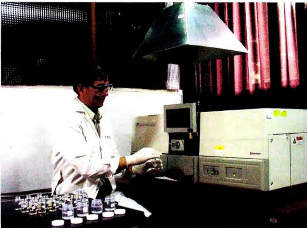
Fig. 31. Evaluación del contenido de plomo, cromo o níquel, lecturas en equipo de absorción atómica.
