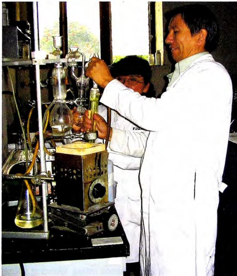
Fig. 11 Equipo micro Kjeldhal, destilación y recolección de amoníaco.
