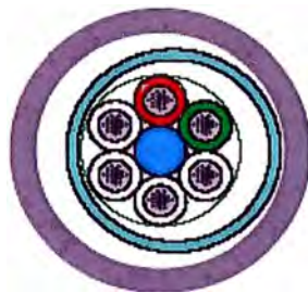
Fig. 4.5 Sistema de Protección de la Fibra Óptica
