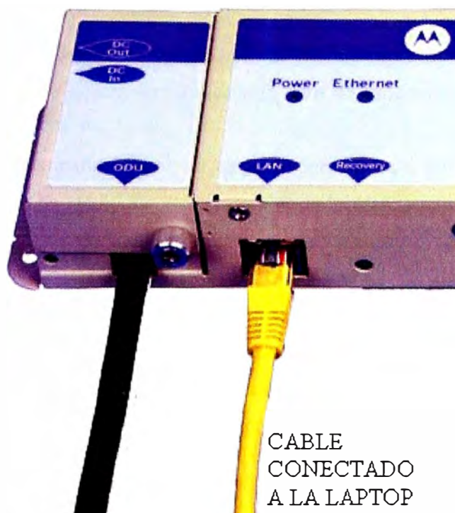
Fig.3.13 Puerto de conexión para las laptops
