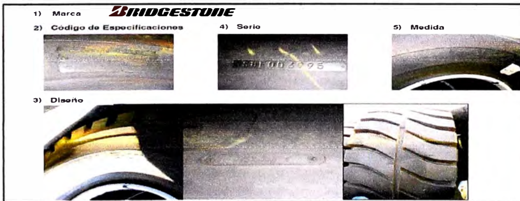
Figura 3.18- Especificaciones de neumático OTR
