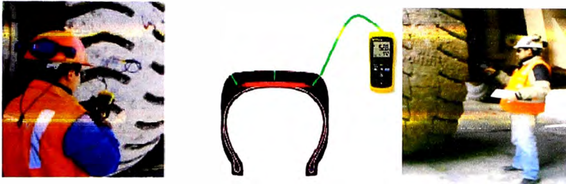
Figura 4.35- Formas para medición de temperatura
