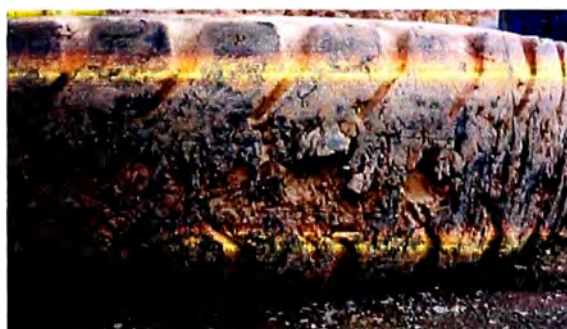
Figura 4.10-Arrancamiento de elementos en banda de rodamiento
