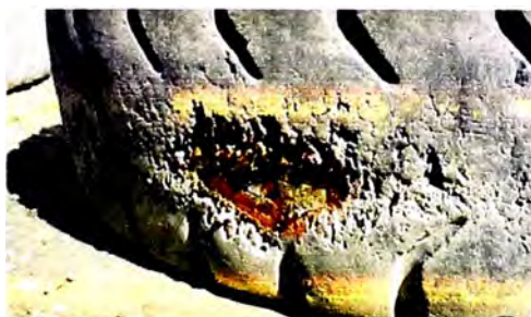
Figura 4.12- Oxidación en los cables de protección del neumático
