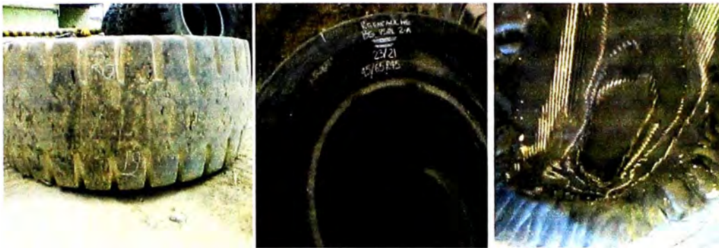
Figura 6.25- Neumático en buen estado para reencauche
