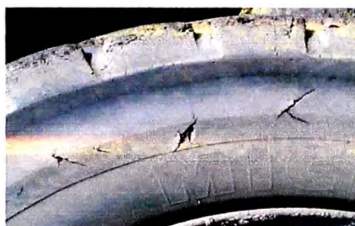
Figura 4.8-Daños en el flanco
