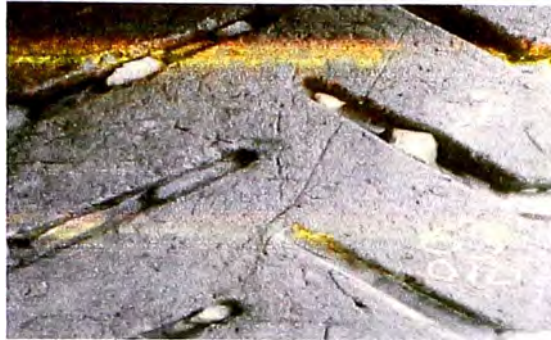
Figura 4.3- Piedra incrustada en la banda de rodamiento del neumático
