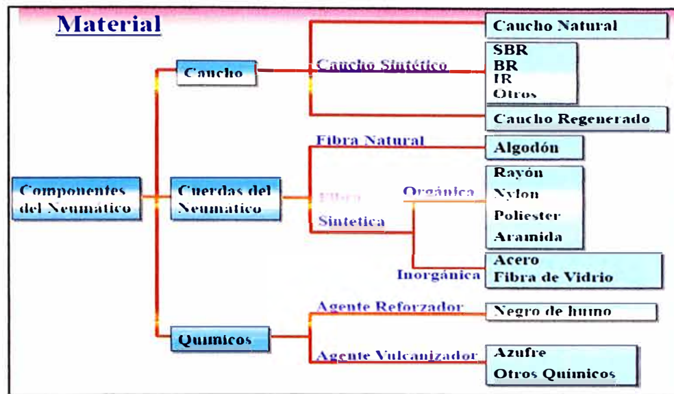
figura 3.16- Insumos para la fabricación de neumáticos
