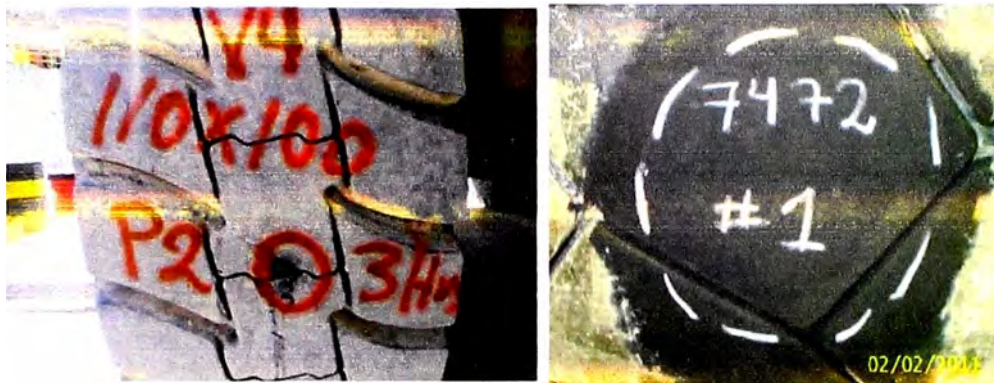
Figura 5.22- Neumático con corte en banda de rodamiento
