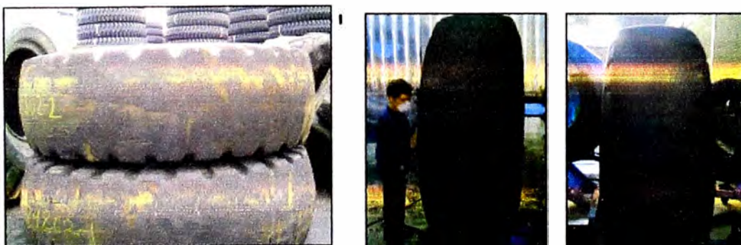
Figura 3.30-Inspeccion de estado de los neumáticos para reencauche
