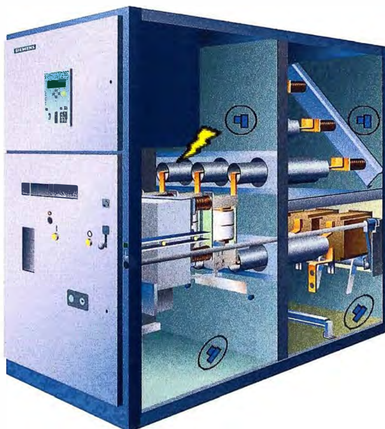
Figura 6.6: Falla en compartimiento de interruptor de una Celda Metal Clad.
