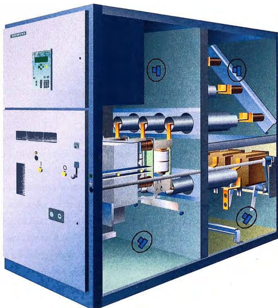
Figura 4.5: Disposición típica de los sensores ópticos dentro de los compartimentos de una Celda Metal Clad.
