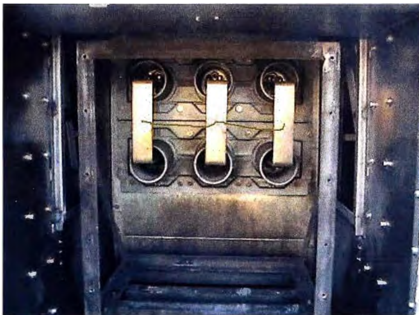
Figura 7.5: Simulación de cortocircuito en compartimiento de interruptor.
