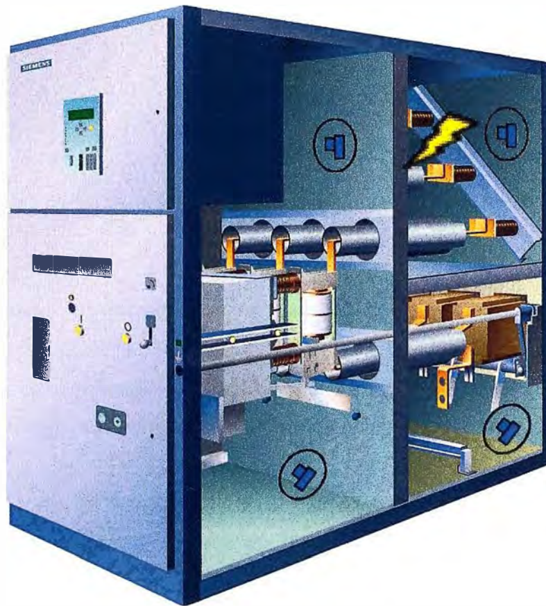
Figura 6.8: Falla en compartimiento de barras de una Celda Metal Clad.
