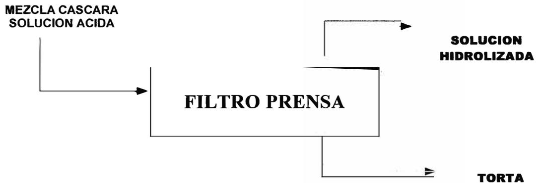
Fig. N° 3.1 Separación en el Filtro prensa
