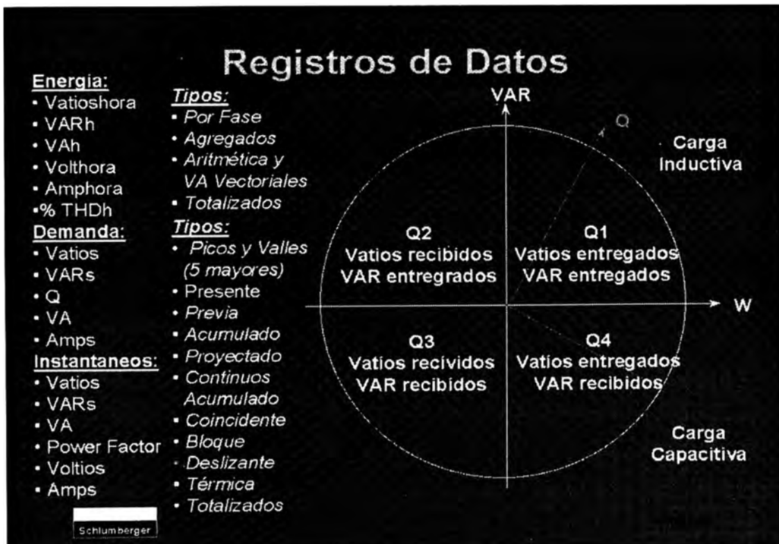
Figura 2.2 Parámetros que registra el medidor electrónico multifunción Quantum 1000 (Referencia: catalogo de medidores electrónicos Schlumberger)
