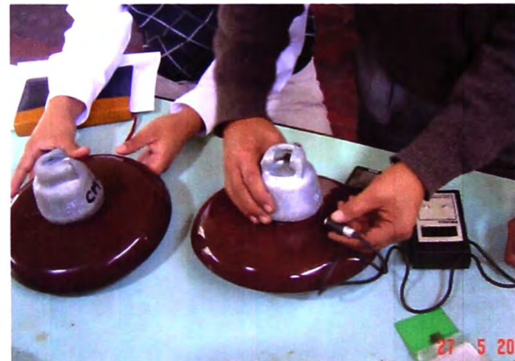
Foto N° 8: Medición del galvanizado - Lab. UNI
