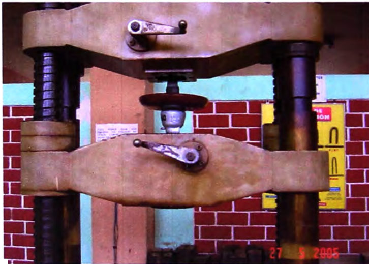
Foto N° 7: Pruebas mecánicas de aisladores - Lab. UNI
