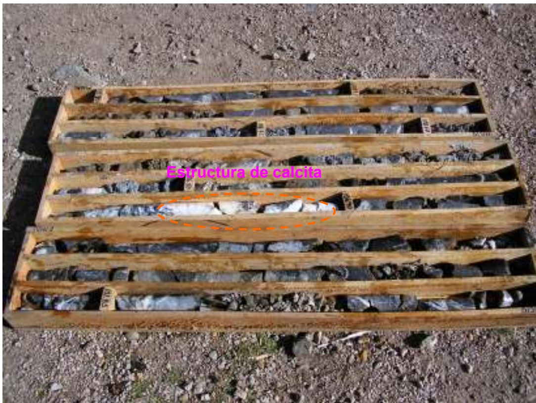
Foto 14. La vista, muestra un tramo de los testigos de perforación con presencia de una estructura de calcita alojada en las calizas del Pucará, sector Yuraccasa.
