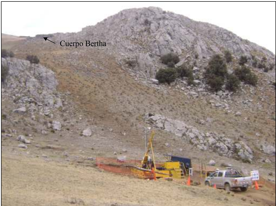
Foto 7.- Mirando al Noreste. La vista, muestra el inicio de las perforaciones profundas en el sector Yuraccasa con el objetivo de interceptar en profundidad al cuerpo Bertha, que es el de mayor dimension en el área.
