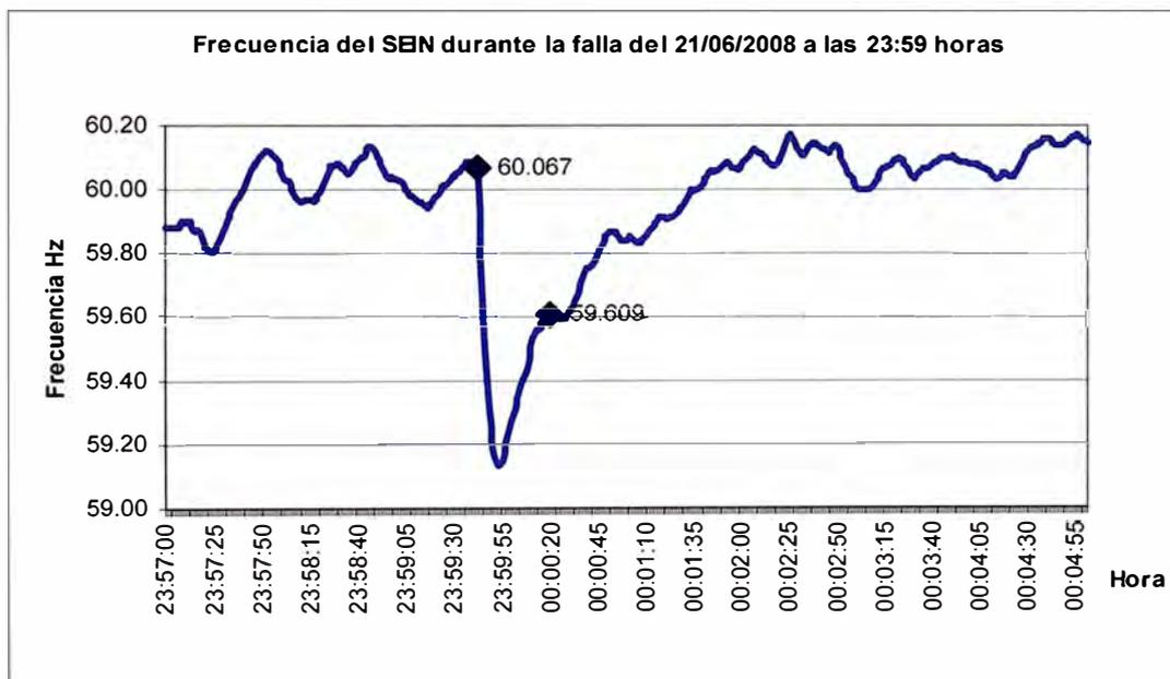
**Fig. 1.8:** Frecuencia del SEIN durante la falla de la unidad TG1 de la C.T. Chilca
