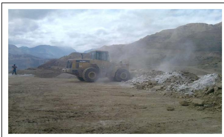
Figura 5.3. Adición de cal y empuje de mineral
