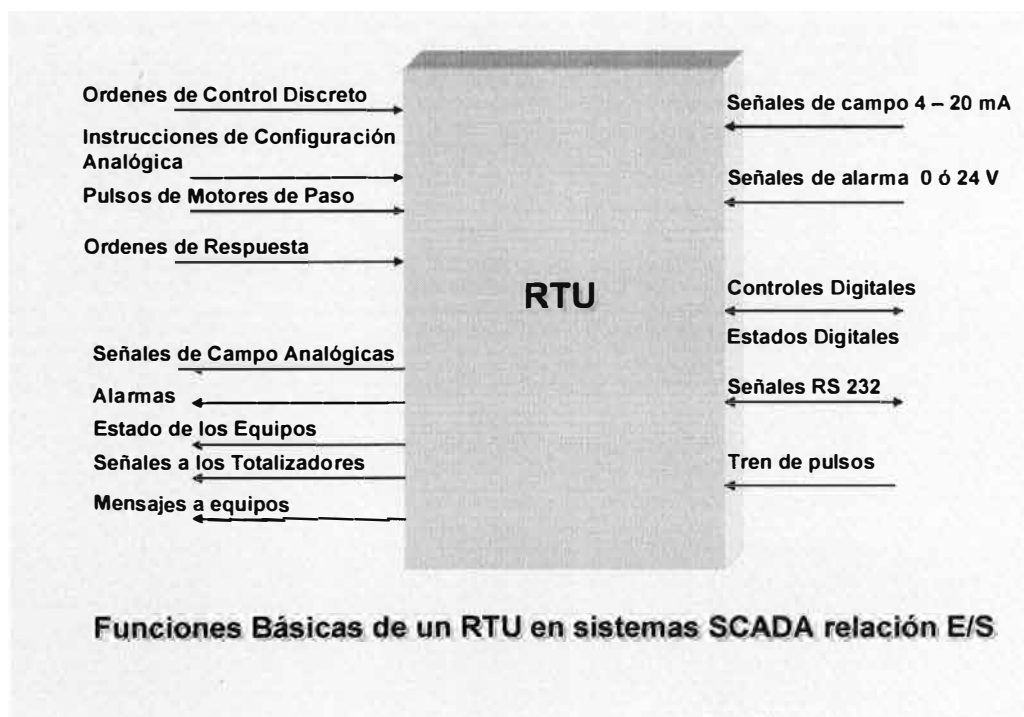
Figura 3.3 Esquema de las funciones básicas de un RTU
