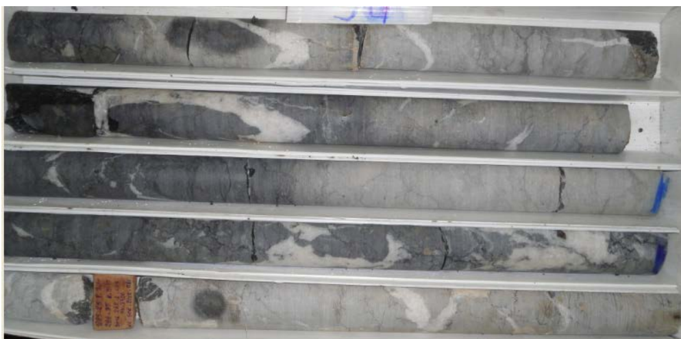
Figura 5.8.- Calculando el RQD se obtiene un valor de 100%
