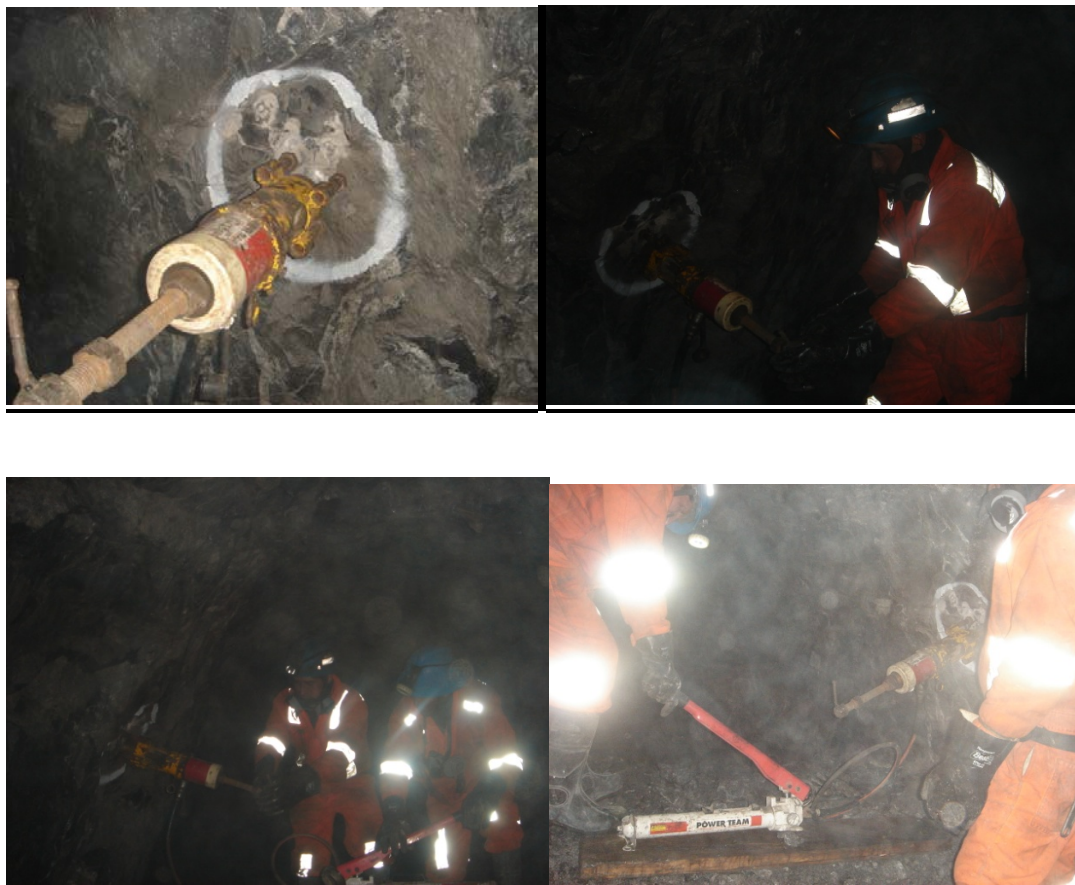
Figura 3.10.- Crucero 290: Resistencia del Split set de 5 pies (Hastial derecho)
