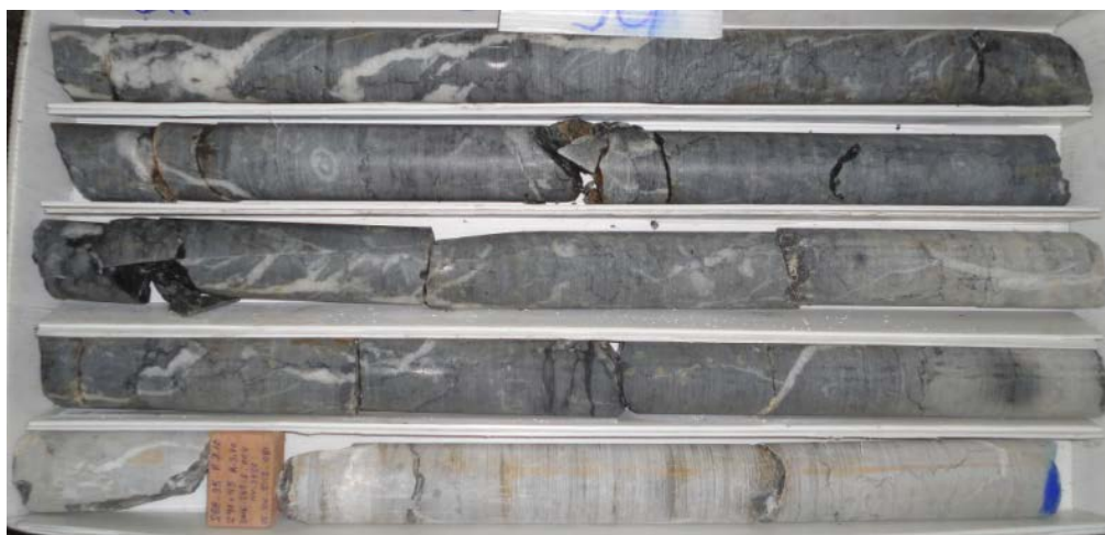
Figura 5.9.- Calculando el RQD se obtiene un valor de 94.4%
