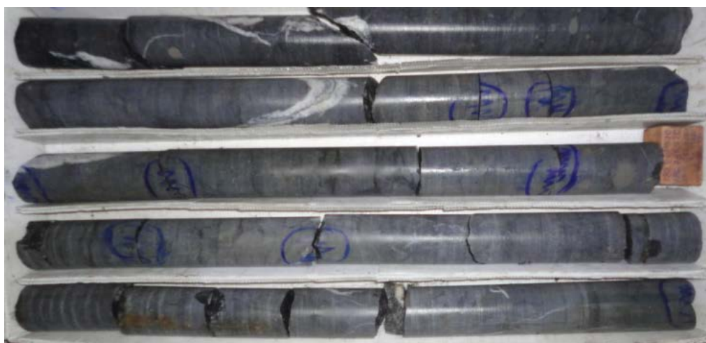
Figura 5.7.- Calculando el RQD se obtiene un valor de 98.2%
