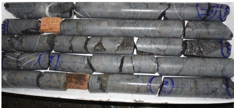
Figura 5.4.- Los círculos marcados en azul me indican que estos sufrieron rotura por el personal calculando el RQD se obtiene un valor de 87.1%
