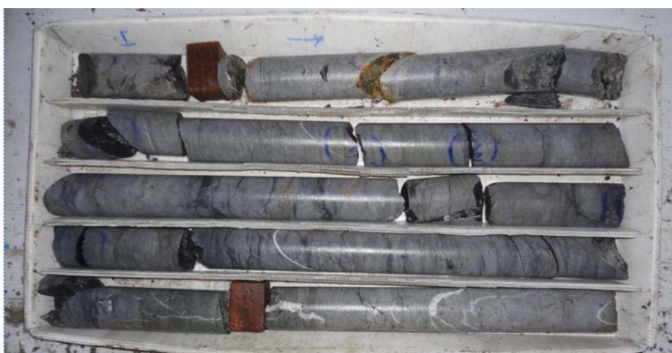
Figura 5.5.- Calculando el RQD se obtiene un valor de 90.8%
