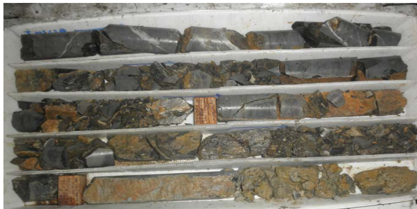
Figura 5.1.- Calculando el RQD se obtiene un valor de 22%
