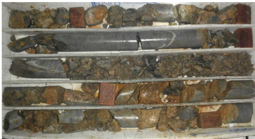
Figura 5.2.- Calculando el RQD se obtiene un valor de 12%
