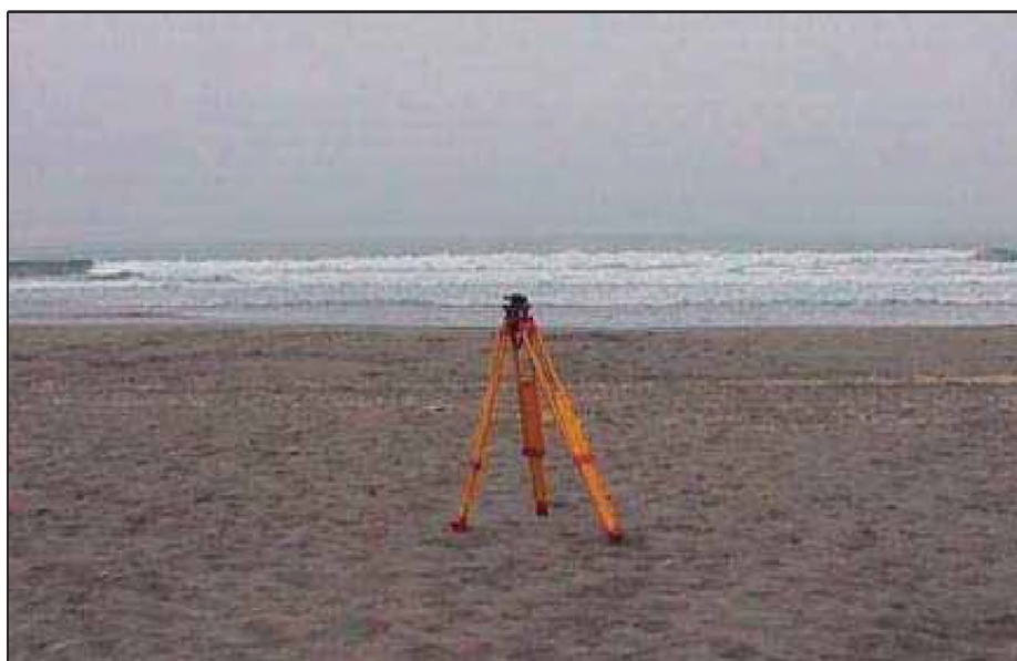
Foto N° 7.59.- Efectuando la nivelacion desde la linea de baja marea para obtener el transecto de la costa
