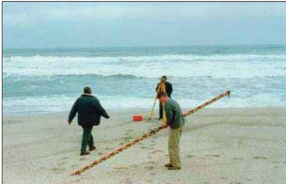
Foto N° 7.69.- Efectuando nivelación en el transecto de Bolivia Mar con ayuda de Brandon, la ola del tsunami alcanzo 2.33 m. Coordenadas: 17°44.458'S; 71°15.479'W
