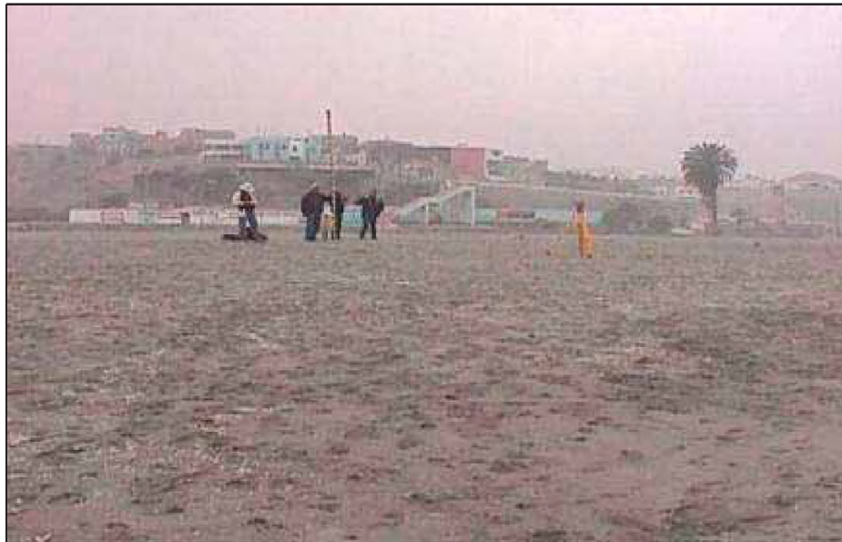
Foto N° 7.55.- Realizando la nivelación en la Playa 1, no se encontro evidencia del Tsunami, debido a la marea baja el Tsunami no paso la marca de la alta marea.
