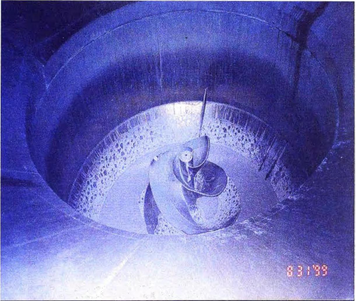
**Foto N° 10: Equipo para repulpar papel (pulper) utilizado en una planta papelera**
