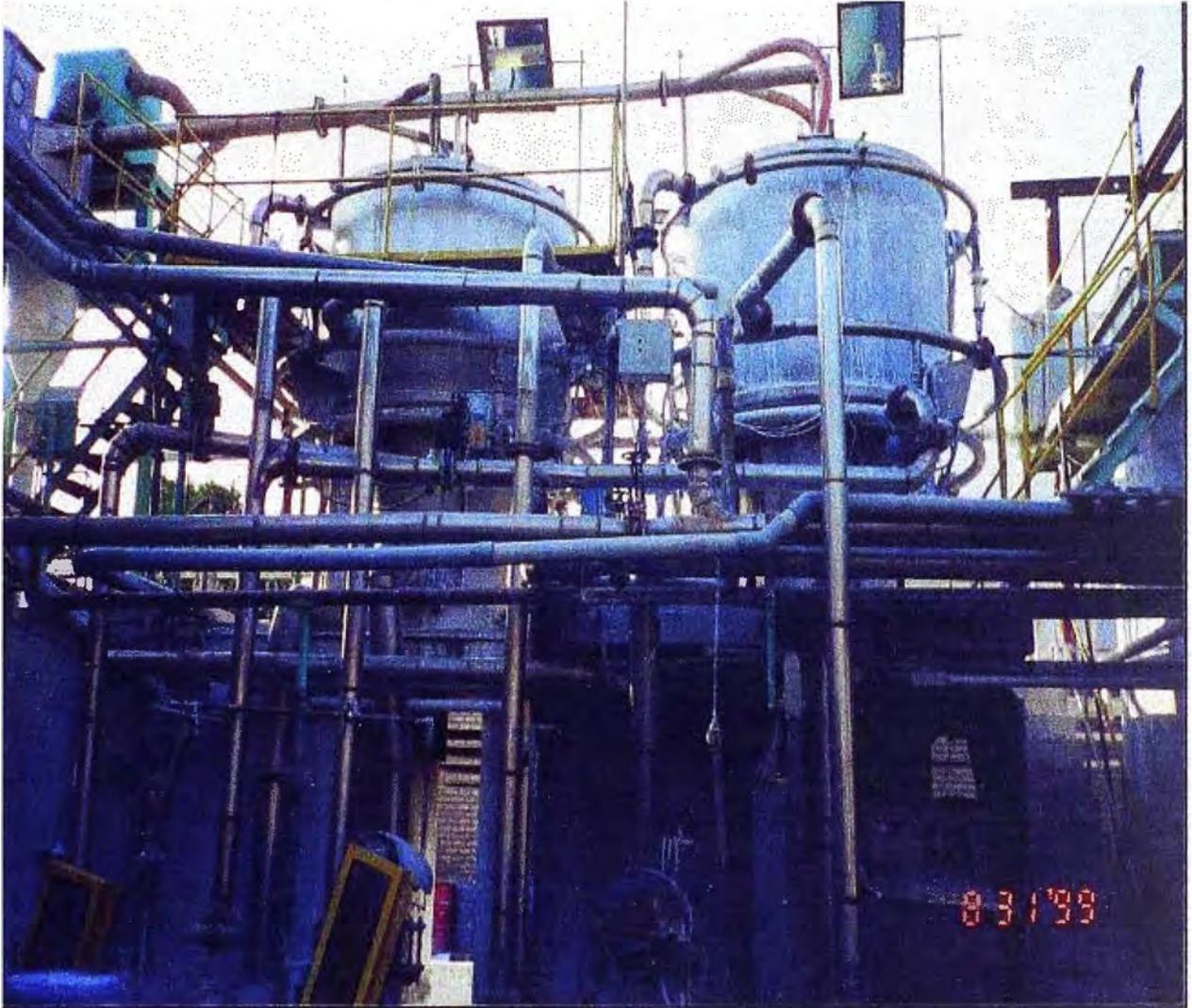
**Foto N° 12: Vista panorámica de celdas de flotación utilizado para el destintado de pulpa de papel en la industria papelera**
