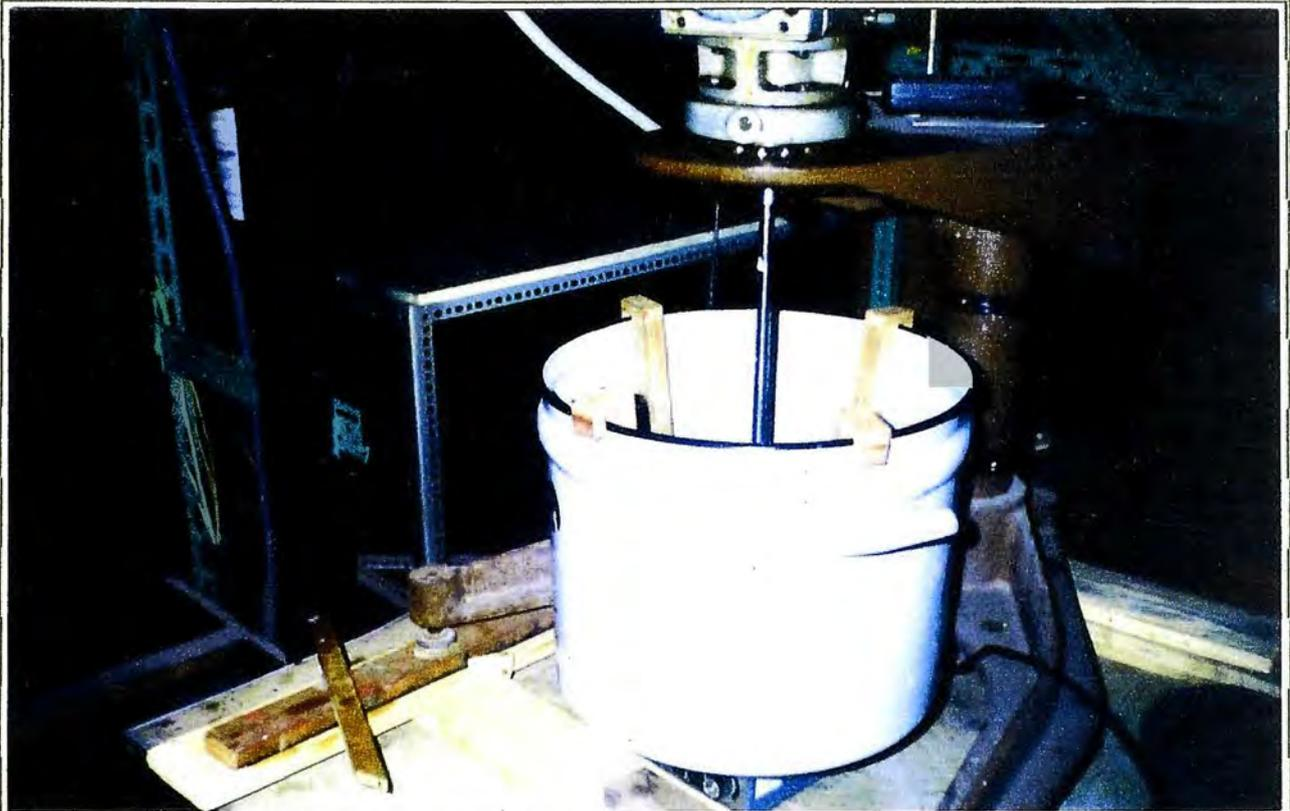
Fotografía N° 2: Vista panorámica del reactor utilizado para repulpar pulpa de papel.
