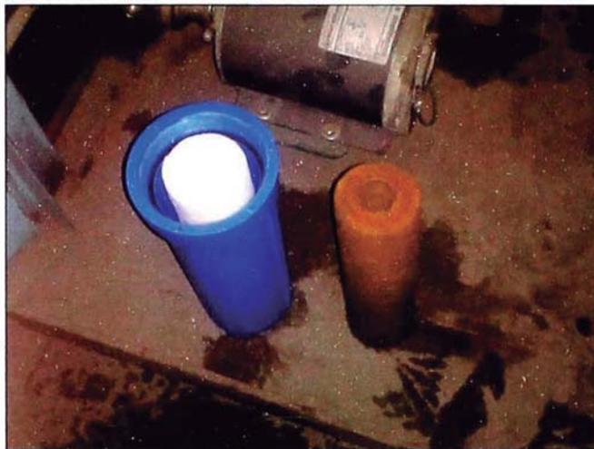
Figura N° 5.49: Filtro de sedimento saturado.
