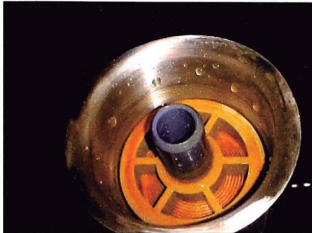
Figura N° 5.51: Membrana de alto rechazo.
