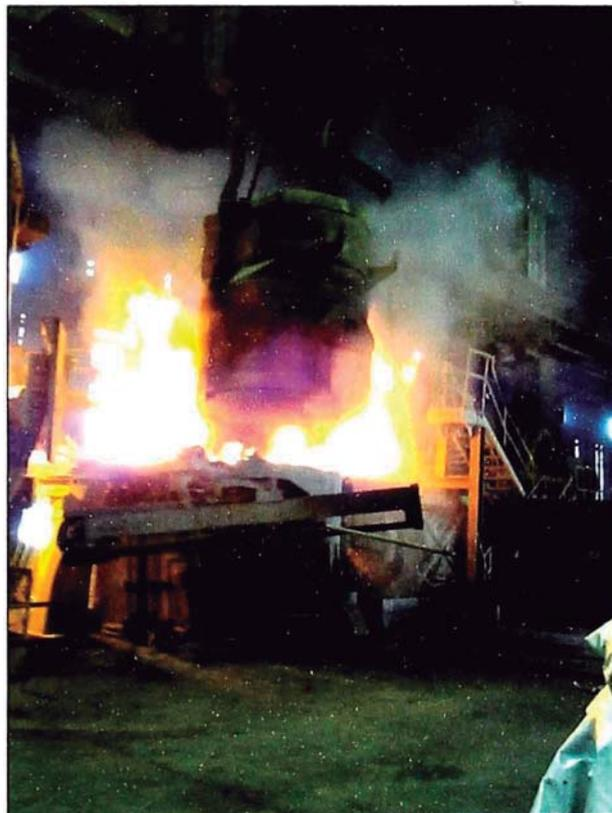
Figura N° 2.16: Carga de Chatarra al Horno Eléctrico
