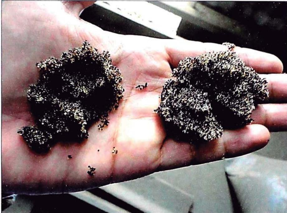
Figura N° 5.40: Resinas mixtas húmedas
