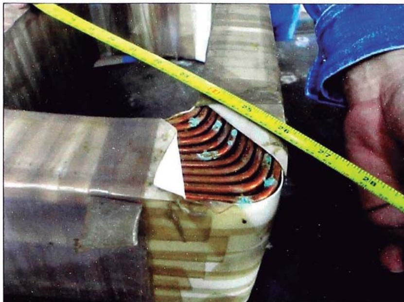
Figura N° 5.45: EMS con depósito de  $\text{CuSO}_4$ .
