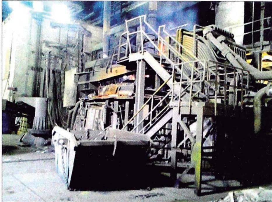
Figura N° 2.17: Etapa de Fusión de Horno Eléctrico.
