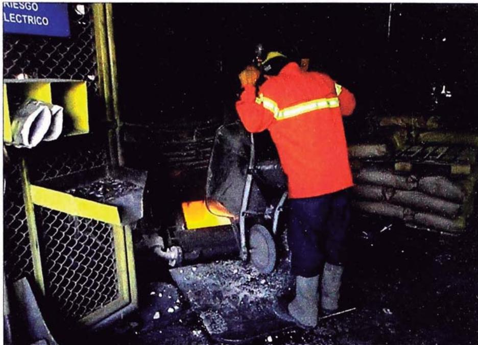
Figura N° 2.18: Adición de Ferroaleaciones en horno cuchara.
