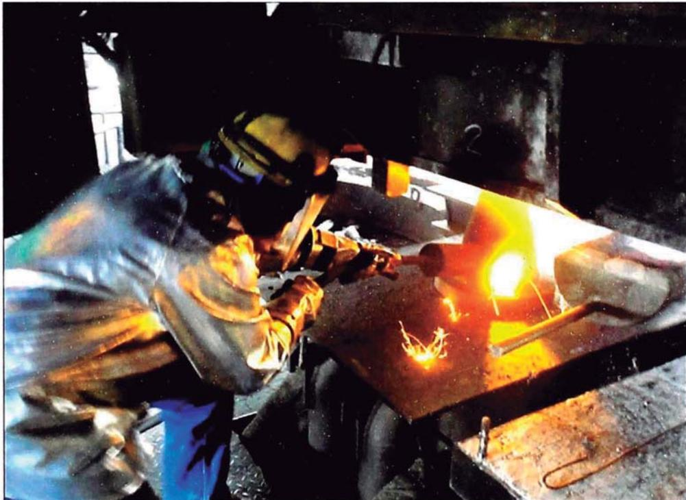
Figura N° 2.21: Instalación de Protector de Chorro en la mesa de colada
