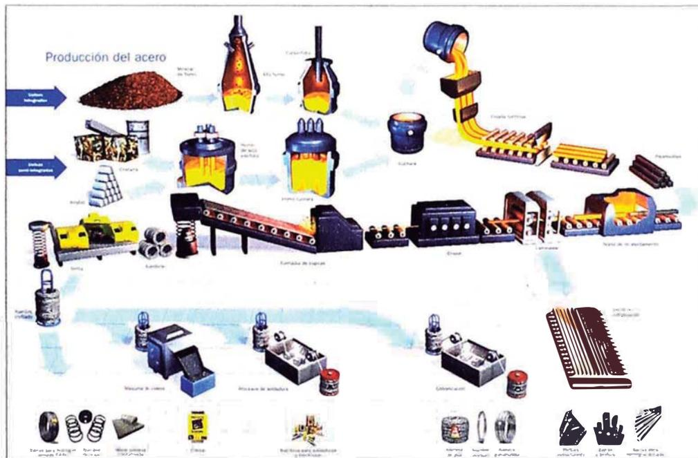
Figura N° 2.9: Planta Integrada de Gerdau (Vía Alto Horno)
