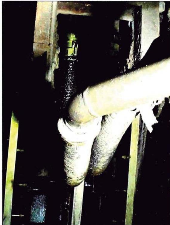
Figura N° 5.53: Fuga de agua en unión de acoples de mangueras del EMS principal.
