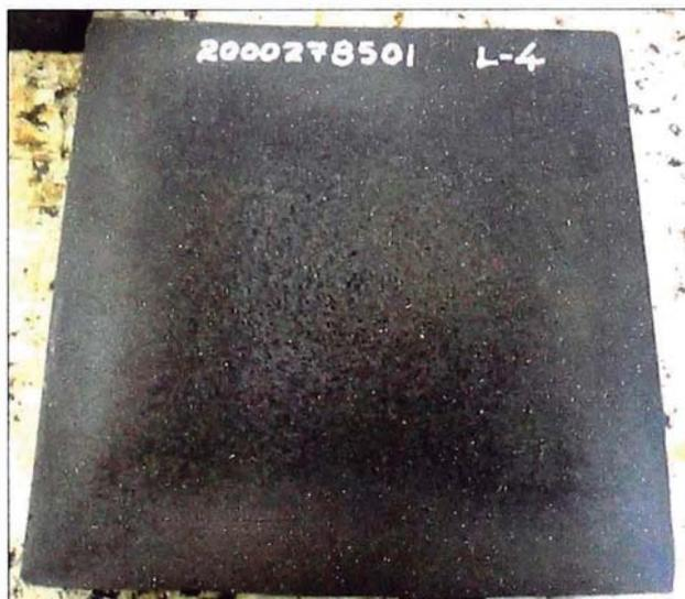
Figura N° 5.5: Sección transversal de tocho
