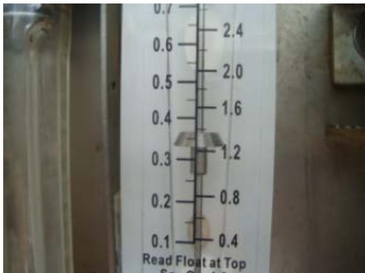
**Figura 3.3:** Flujómetro de un MMU.
