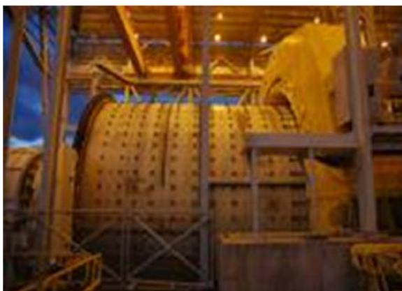
**Figura 2.4:** Molino SAG Mill
