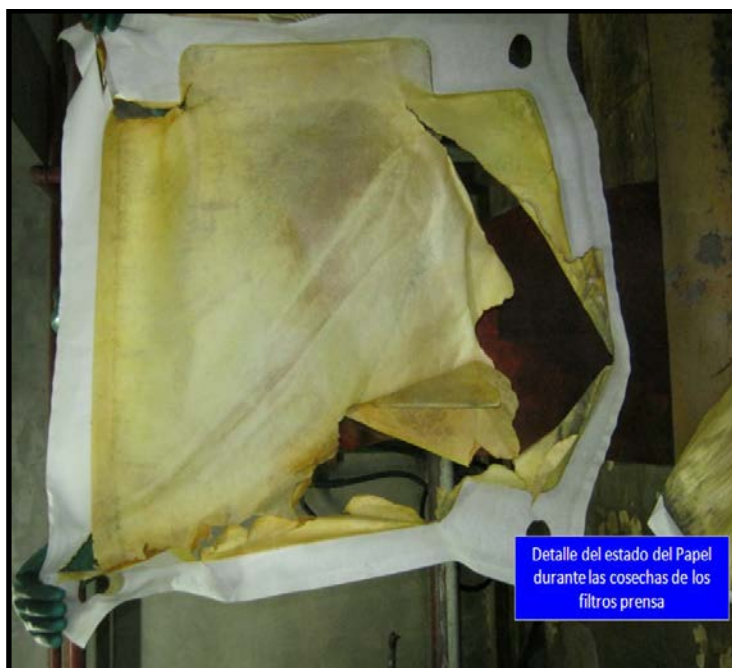
Figura 3.3.- Estado del papel filtro durante la cosecha de los filtros prensa
