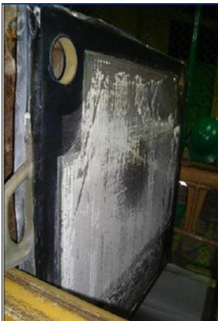
Figura 3.10.- Pre-capado de los filtros prensa, se puede apreciar la capa blanca de ayuda filtrante sobre la funda
