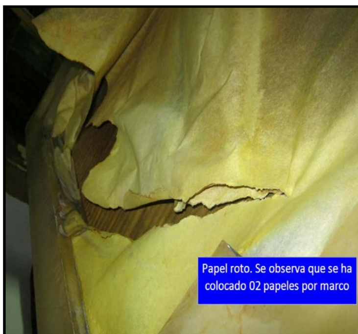
Figura 3.2.- Papel roto, se puede ver que se han colocado 2 papeles filtro juntos
