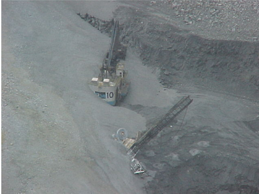
Fotografía 1.2 Perforadoras y camión impactados por la falla de talud de la mina Grasberg.
