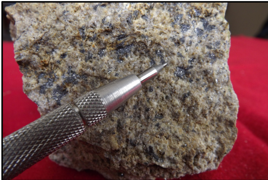
Foto 4.2: Diseminación de galena y willemita (color crema/blanca) en caliza fuertemente dolomitizada con recristalización de calcita, muestra tomada del Manto Astucia
