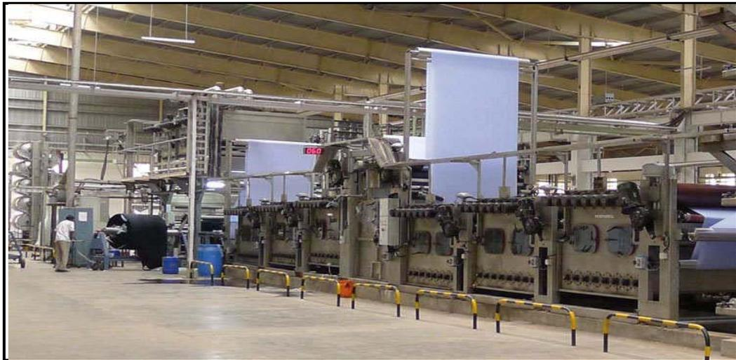
**Figura 3.14:** Máquina de teñido Pad steam
