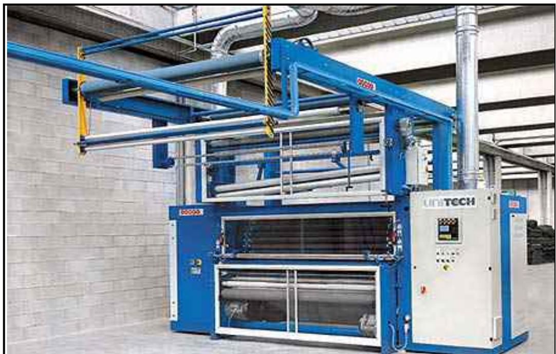
**Figura 3.12:** Máquina esmeriladora Unitech
