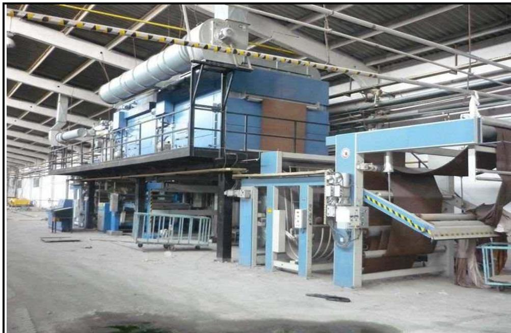
**Figura 3.13:** Máquina de teñido Thermosol
