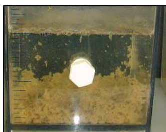
Figura 3.38 Resultado con FeCl 3 (250 ppm) y CF-305 (10 ppm)
