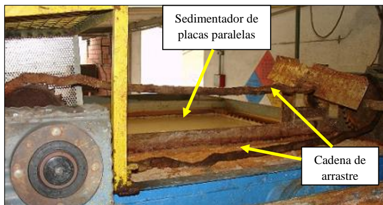
Figura 4.25 Cadena de arrastre de flóculos flotantes
