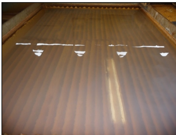
Figura 4.20 Sedimentador de placas paralelas
