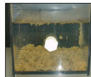
Figura 3.39 Resultado con FeCl 3 (250 ppm) y M-1011 (10 ppm)
