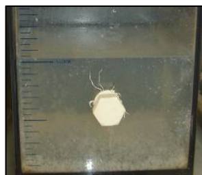
Figura 3.41 Resultado con PAC 100 (680 ppm) y CF-305 (10 ppm)
