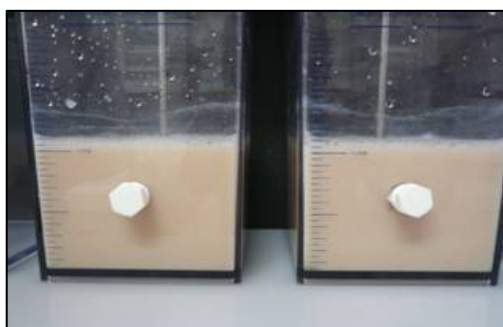
Figura 3.3 En ambas jarras con FeCl 3 al 10% con 1500 ppm
