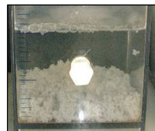
Figura 3.37 Resultado con PAC 100 (1200 ppm) y M-1011(10 ppm)
