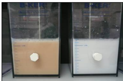
Figura 3.1 Con \text{FeCl}_3 al 1% a 1000 ppm (izq.) y \text{Al}_2(\text{SO}_4)_3 al 1% a 1000 ppm (der.)
