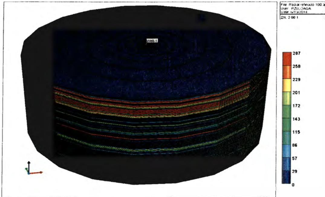
Figura 16. Modelo de simulación radial con refinamiento vertical.
