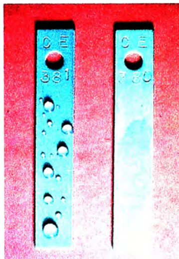
Figura 25. El cupón 381 muestra la superficie impermeable producida por la amina filmica.
