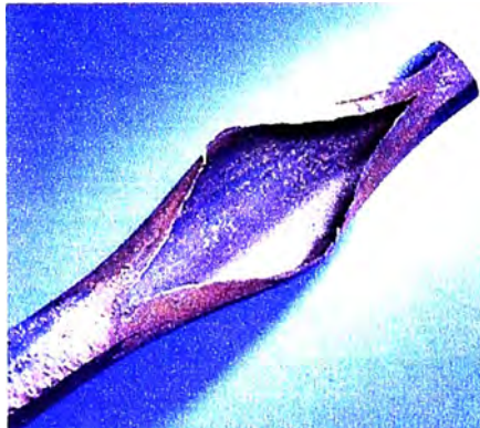
Figura 21. Falla Típica de un tubo por recalentamiento. [17]
