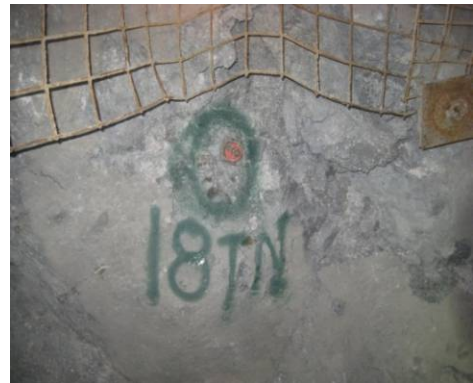
Resultado de la prueba de arranque de un Hydrabolt bien instalado
