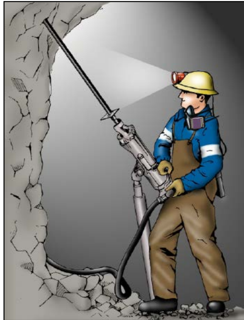
Fig. N° 40 Instalación del Perno Split Set
