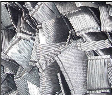
Foto N° 8 - Fibra Metálica para Shotcrete Vía Húmeda (Encolada 65/35)
