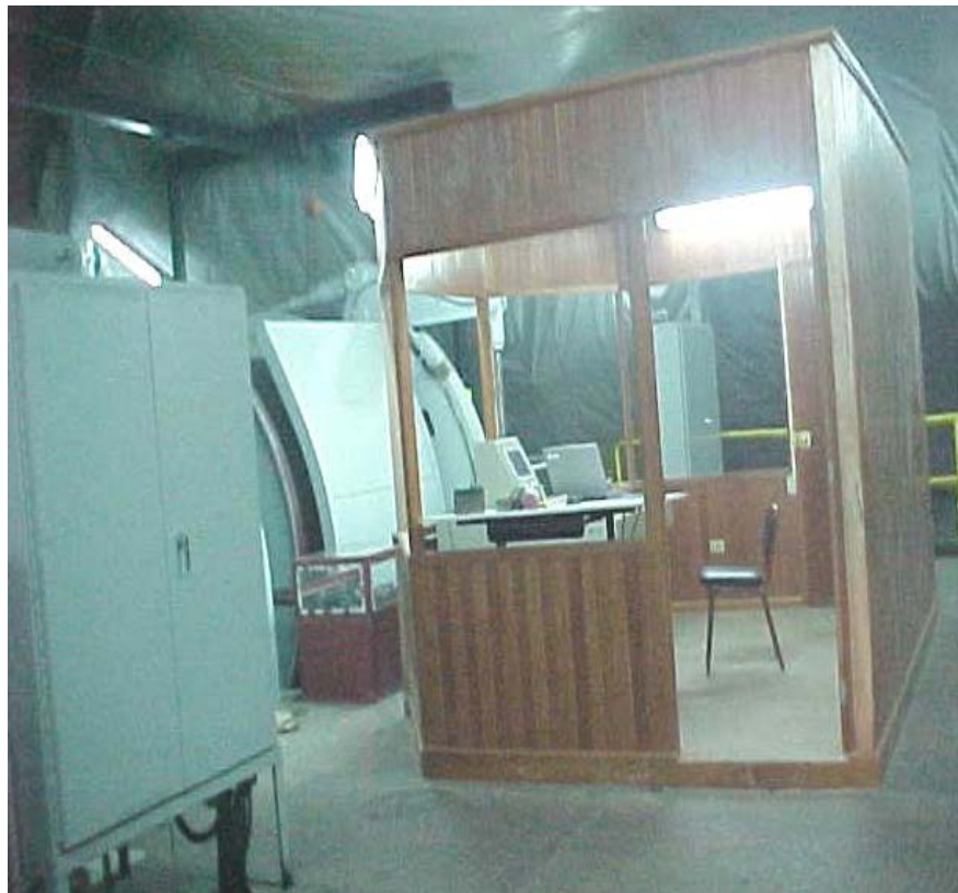
Fig. 10 Pique Luz, Cabina de Control, Nivel 450. El Pique consta de una wincha de 1500 HP, trabaja con 2 skips de 7,5 TC y una jaula integrada en el skip Nro. 02 con capacidad para 9 personas .
