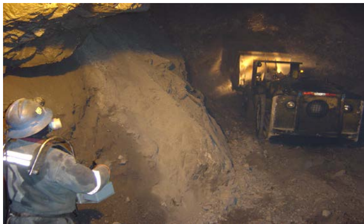
Fig.9 Scoop diesel de 2,2, yd3 a control remoto, en plena limpieza desde un draw point en el tajo 775 Cuerno Marav Nv 060 Mina Socorro
