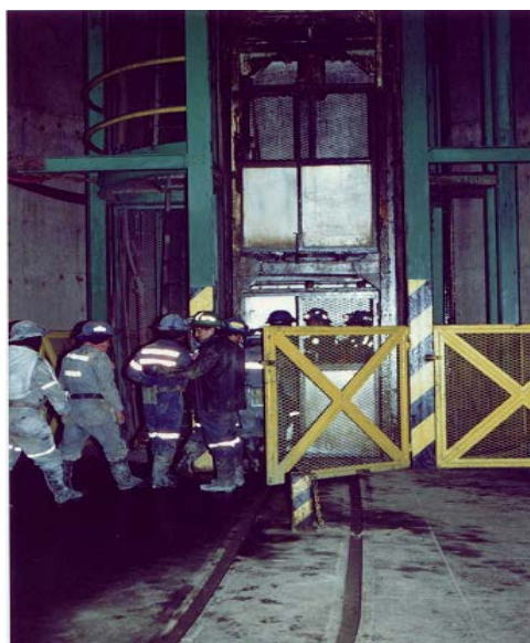
Fig. 11 Pique Master, estación principal en el Nv. 450, donde se transporta mineral a los diferentes niveles, la jaula es de 2 pisos, con capacidad para 30 personas. La Wincha Nro 01, tiene un motor de 300 HP, marca Nordberg.
