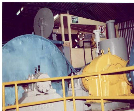
Fig. 11 Pique Master, estación principal en el Nv. 450, donde se transporta mineral a los diferentes niveles, la jaula es de 2 pisos, con capacidad para 30 personas. La Wincha Nro 01, tiene un motor de 300 HP, marca Nordberg.
