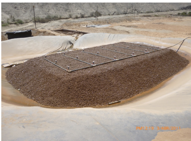
Figura N° 4.17 Esquema del regado del Pad
