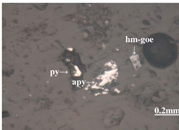
Figura N° 4.12: Cancha relavera N°2 - Nícoles paralelos. Granos libres de arsenopirita (apy), pirita (py), ganga (GGs) y grano mixto de hematita-goetita (goe).
