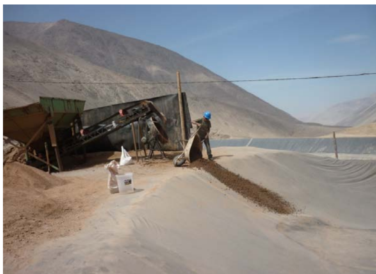
Figura N° 4.14 Deposición del relave aglomerado
