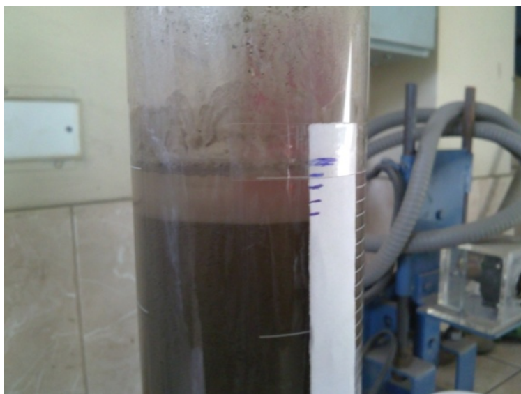
Fig. 3.4 Prueba de sedimentación en probeta
