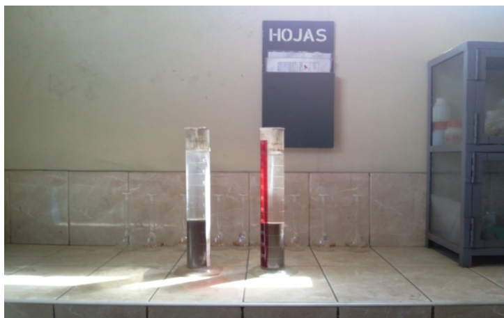
Fig. 3.5 Agua clarificada con adición de 20 gr/tn de floculante aerofloc A110
