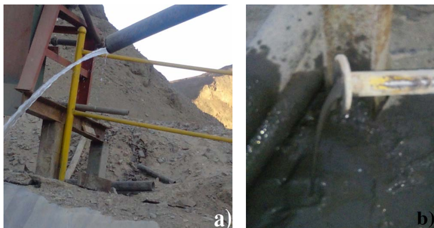
Fig. 3.8: a) Overflow (reboce de solución clara del cono espesador), b) underflow (descarga de pulpa espesa del cono espesador)
