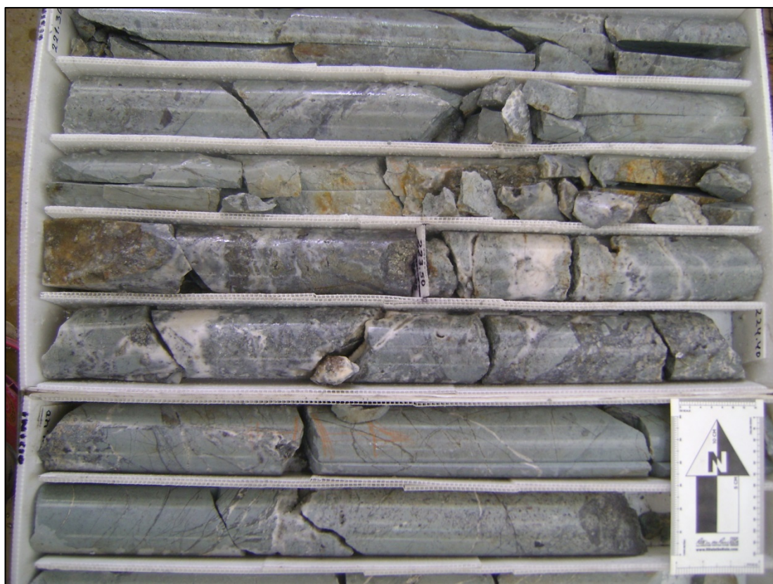
Figura N°5.11: Nótese la marga de color verdoso con fuerte Silicificación y moderada Cloritización.
