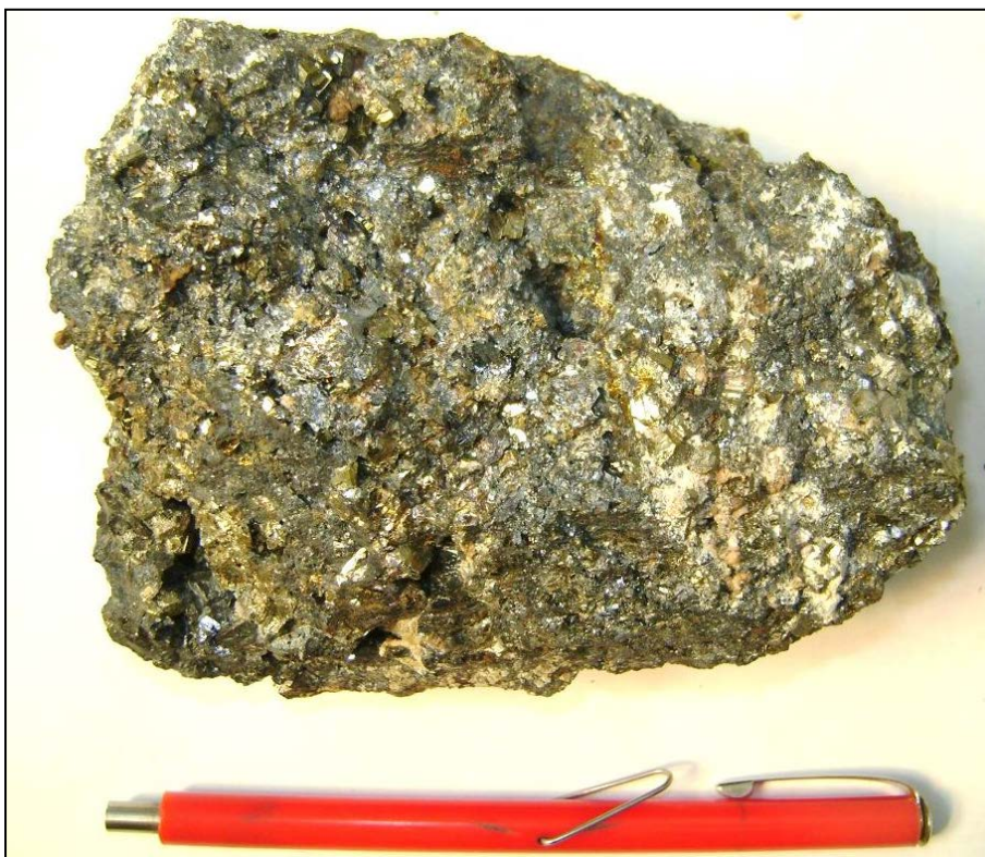
Figura N°5.10: Muestra de la Veta Islay: galena argentífera, ef. y platas rojas.
