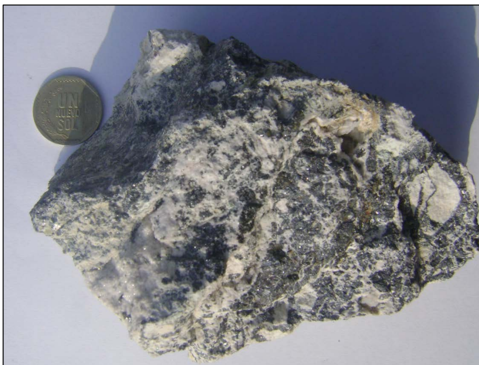
Figura N°5.1: Muestra de mano de la Veta Islay, con presencia de galena, esfalerita, platas rojas escasa, calcita y rodocrosita.
