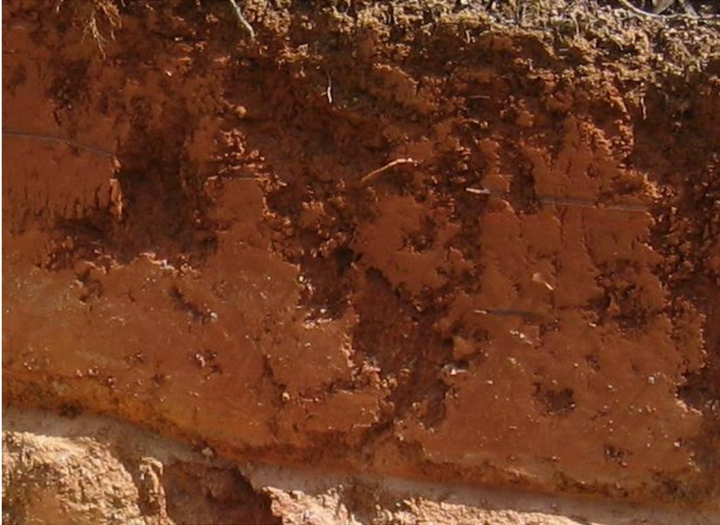
**Fotografía # 04:** Nivel correspondiente al suelo laterítico, suele contener frecuentemente pisolitos concéntricos.
