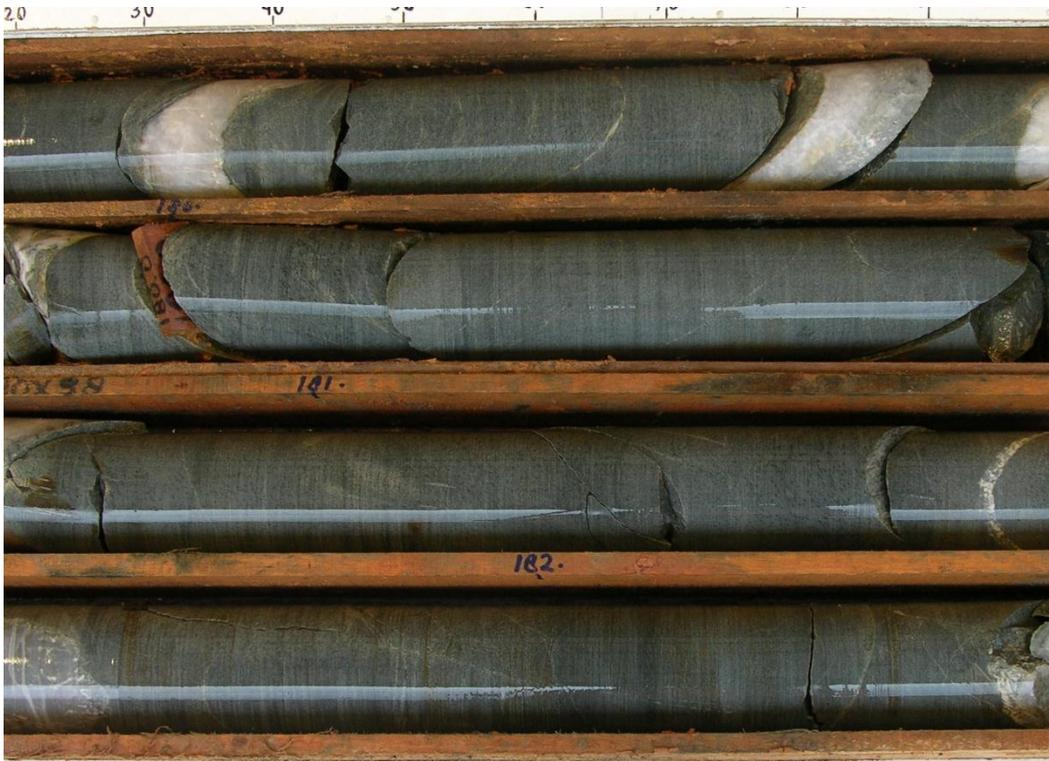
**Fotografía # 09: Testigo de perforación diamantina mostrando la denominada “roca fresca” donde se puede observar las estructuras primarias, además de granulometría y otras características originales.**
