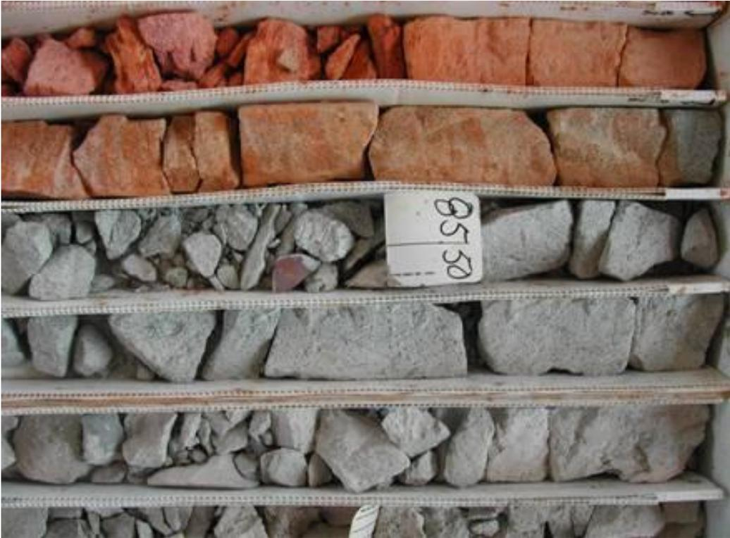
**Fotografía #08:** Testigos de perforación diamantina mostrando la roca saprolítica, esta se caracteriza por su singular textura, al ser una zona de transición hacia la roca fresca, posee características de ambos es decir es más dura que la saprolita, pero más débil que la roca fresca.
