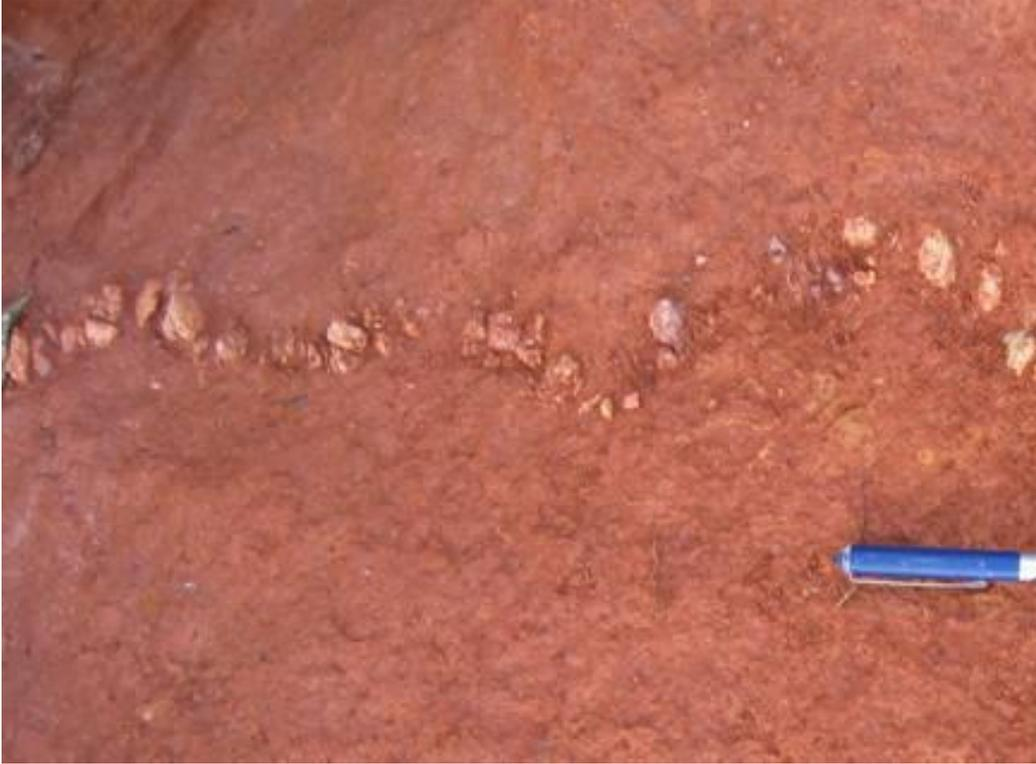
**Fotografía # 05: Zona arcillosa caracterizada por conservar las estructuras primarias a pesar de su gran intemperismo.**
