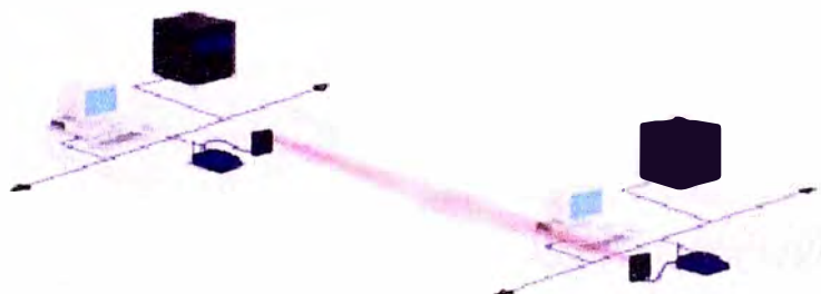
Figura 3.2.-Interconexión de LAN mediante antenas direccionales
