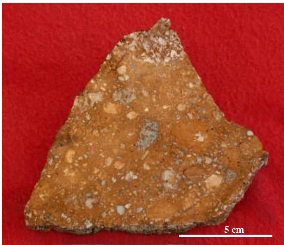
Foto N° 29: Fragmentos subredondeados y heterolíticos en matriz mixta (polvo de roca+cristales rotos) A diferencia de la brecha, foto N° 28, ésta es de mayor energía. 20694E; 28114N Brecha Freatomagmática ( BxFM )
