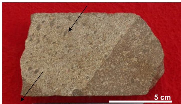
Foto N° 12: Inyección de unidad porfírica. Fíjese el alineamiento de cxs. totalmente frescos.
