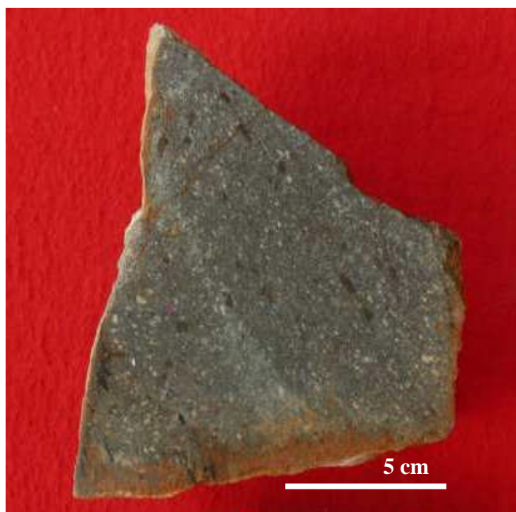
Foto N° 4: Muestra de mano del dique de la foto anterior N°3. Nótese el carácter porfírico con la presencia de ferro magnesianos (hornblenda en color oscuro) y cristales de Plg en color blanco todo ello en matriz textura fanerítica.
