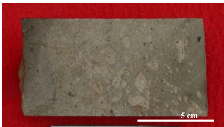
Foto N° 17: Brecha Intrusiva dentro de la secuencia porfirítica Pad. Fijese la matriz porfirítica con fenocristales de ferro magnesianos englobando también fragmentos porfiríticos. ARN-03; 170.90m Pad
