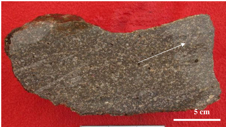
Foto N°18: Muestra de mano de la foto N° 8. Fíjese alineamiento de cxs. de Plg, ferromagnesianos.
