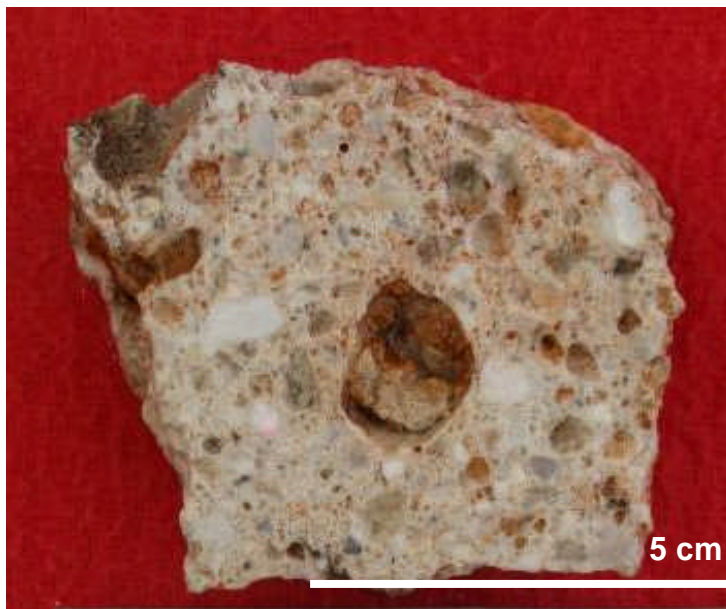
Foto N°28: Fragmentos heterolíticos, subredondeados englobados en matriz juvenil (oquedades) y polvo de roca.
