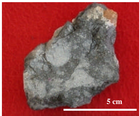
Foto N° 35: Brecha Freatomagmatica con alteración argílica (cly+Py)
