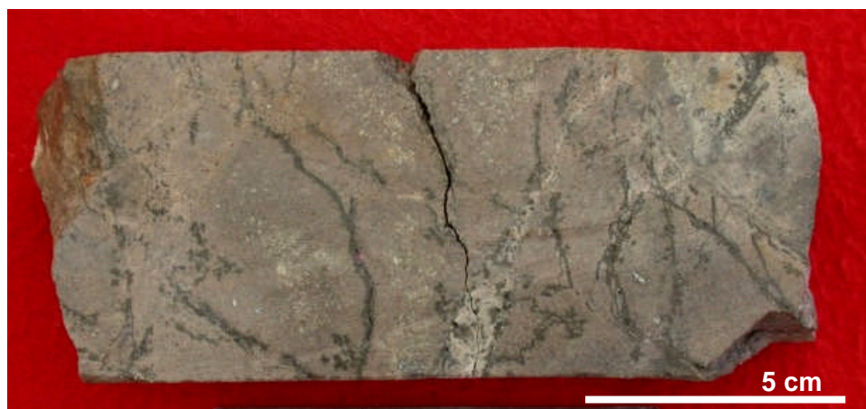
Foto N° 21: Tufo de cristal de textura fina, en la cual se observa numerosas vetillas de Py y Py+Sil. ARN-09, 378.6m Tx
