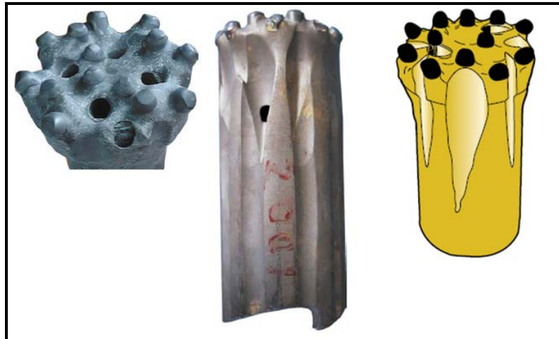
FIGURA 75: ROTURA DE BROCA POR LAVADO DE CUERPO
