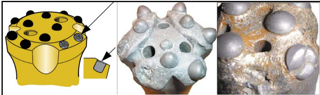
FIGURA 85: INSERTOS DESTRUIDOS BAJO EL NIVEL DEL CUERPO DE LA BROCA
