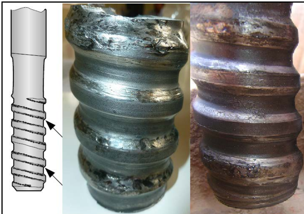
FIGURA 91: DESGASTE EN LAS ROSCAS DE LAS BARRAS
