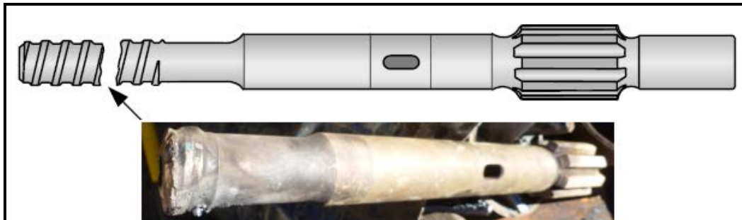
FIGURA 102: FALLA Y PICADURAS EN ROSCAS
