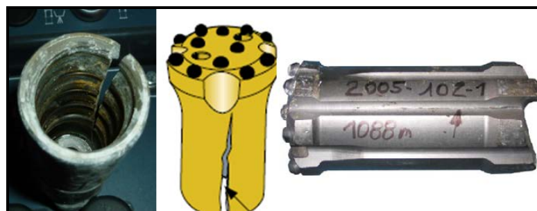
FIGURA 76: ROTURA POR RAJADURA EN EL BORDE DE LA BROCA
