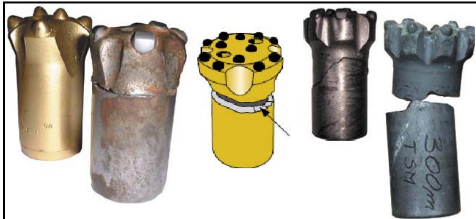
FIGURA 79: ROTURA ANULAR EN EL CUERPO DE LA BROCA
