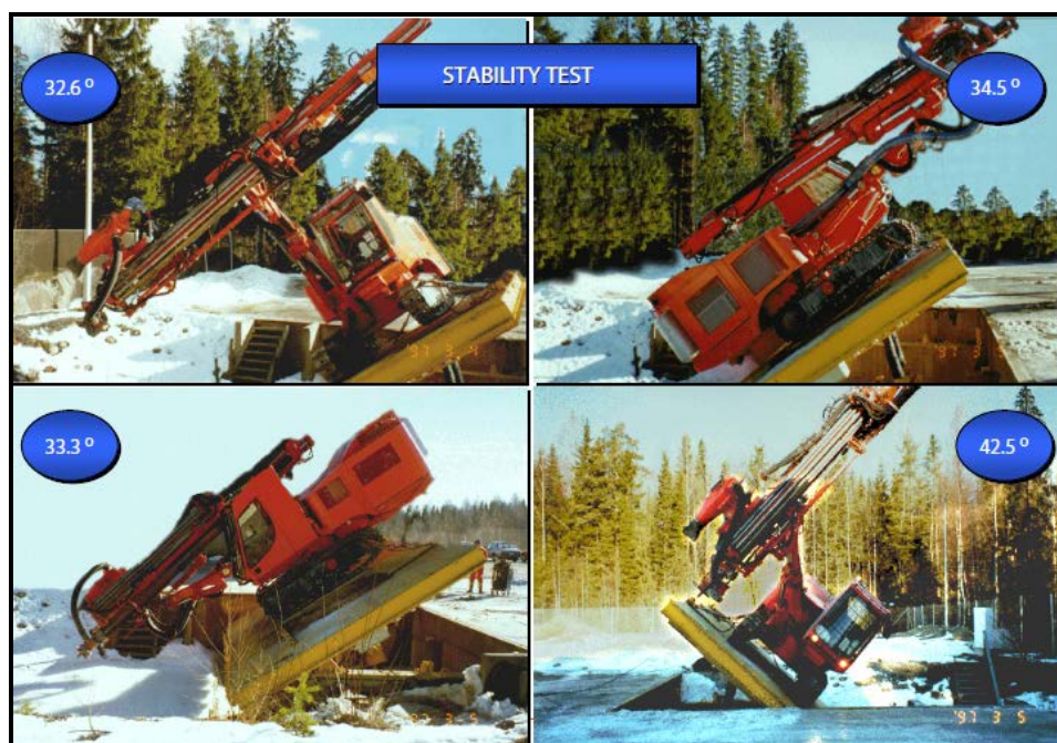
FIGURA 67: PRUEBA DE ESTABILIDAD DE LOS EQUIPOS DPS
