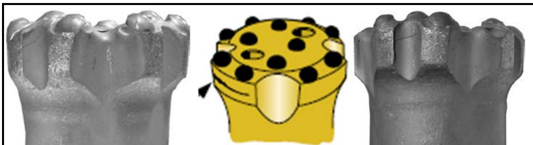
FIGURA 78: RAJADURA EN LA PARTE INFERIOR DE LOS INSERTOS
