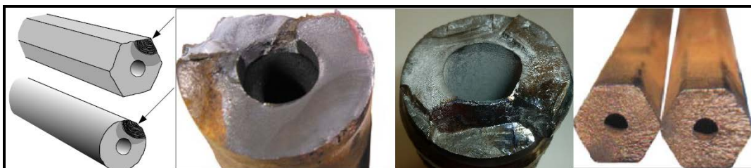
FIGURA 89: SUPERFICIE DAÑADA DE LA BARRA
