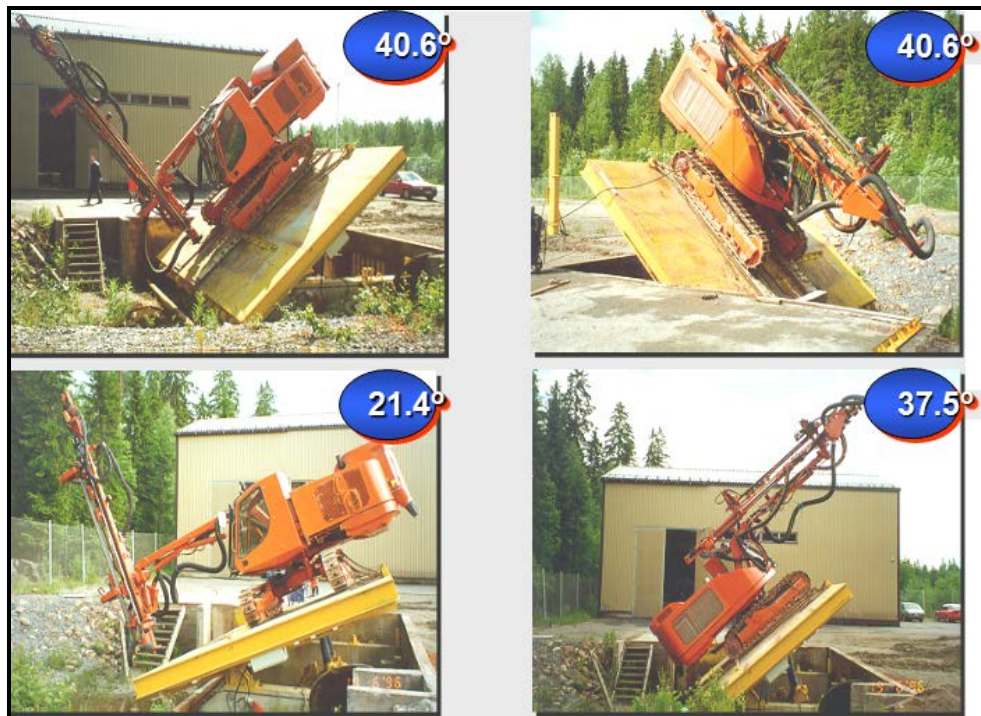
FIGURA 65: PRUEBA DE ESTABILIDAD DE LOS EQUIPOS DXS
