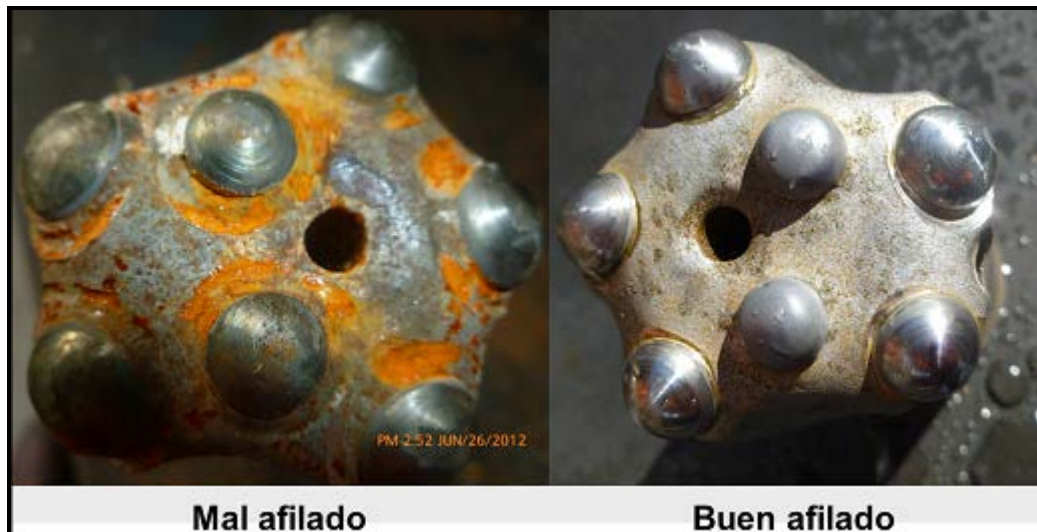
FIGURA 116: DIFERENCIA ENTRE MAL Y BUEN AFILADO DE INSERTOS
