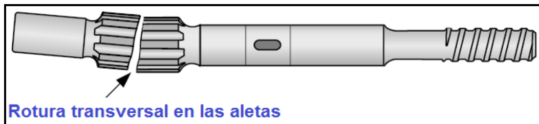
FIGURA 99: FALLA A TRAVÉS DE LAS ALETAS
