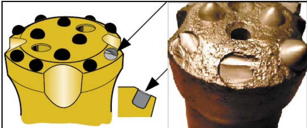
FIGURA 87: DESPRENDIMIENTOS DE INSERTOS A NIVEL DEL CUERPO DE LA BROCA
