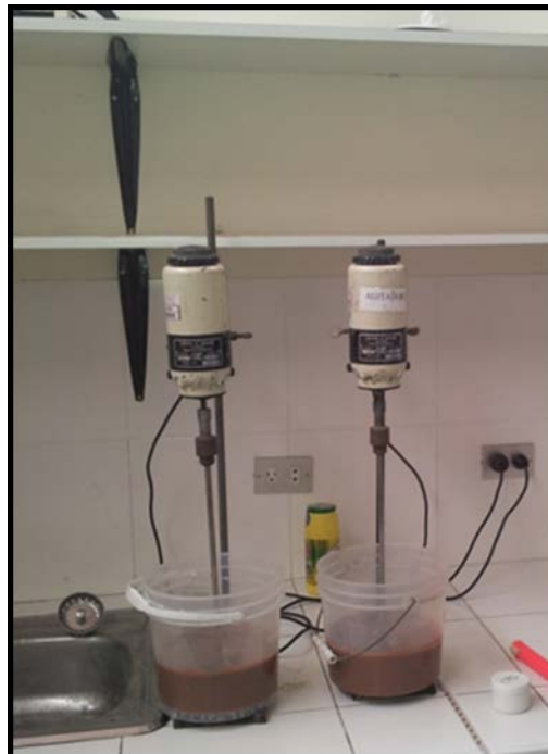
Figura 3.6.- Proceso en laboratorio de la cianuración CIP y CIL
