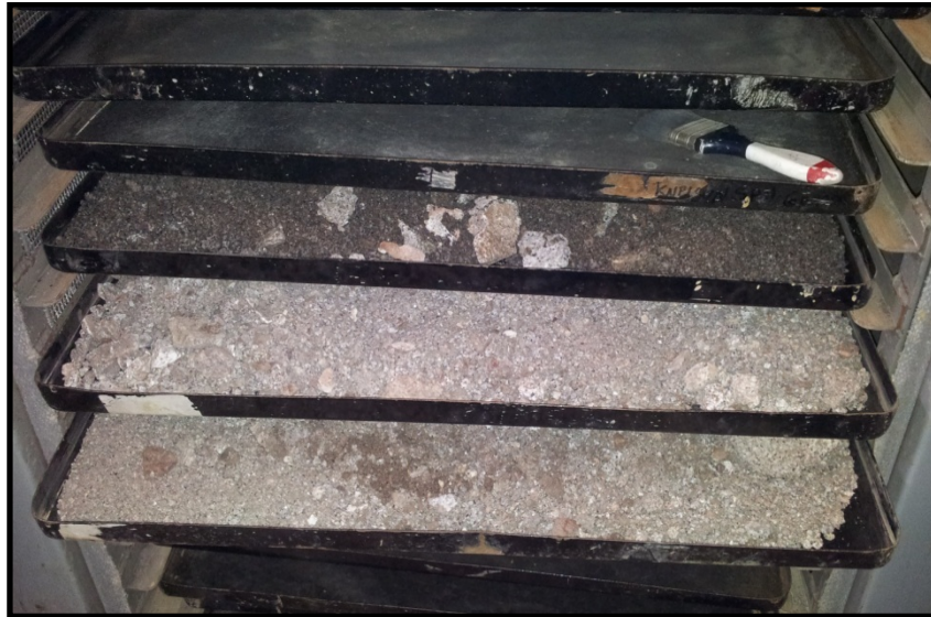
Figura 3.1.- Secado de mineral en estufa de alta capacidad.
