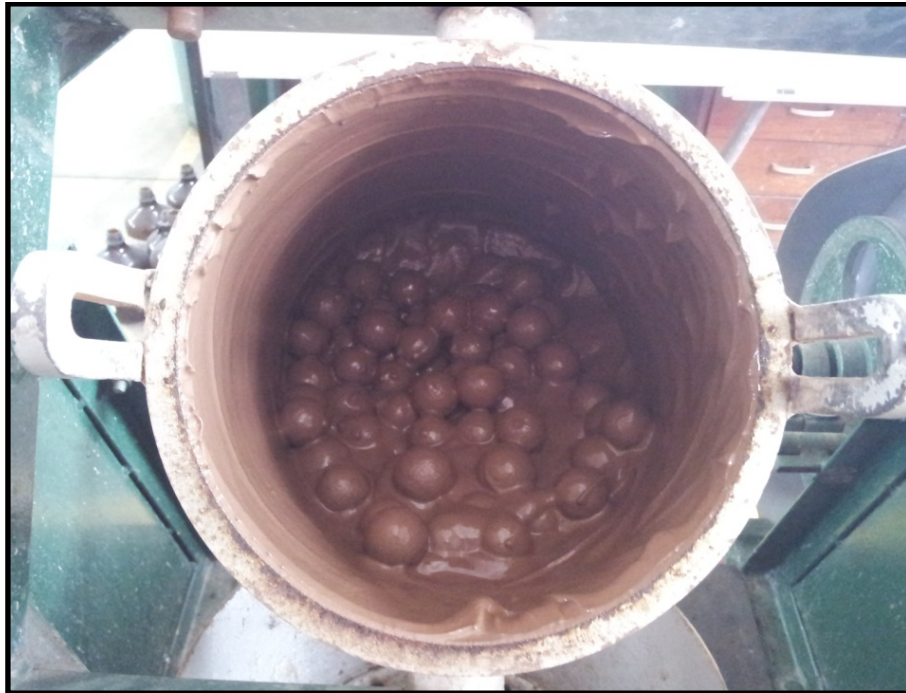
Figura 3.2.- Molienda de mineral a 66% de sólidos tiene una consistencia de alta viscosidad.
