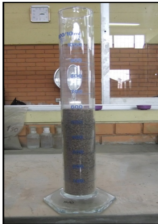
Figura 3.4- Medida de la Densidad aparente del mineral.
