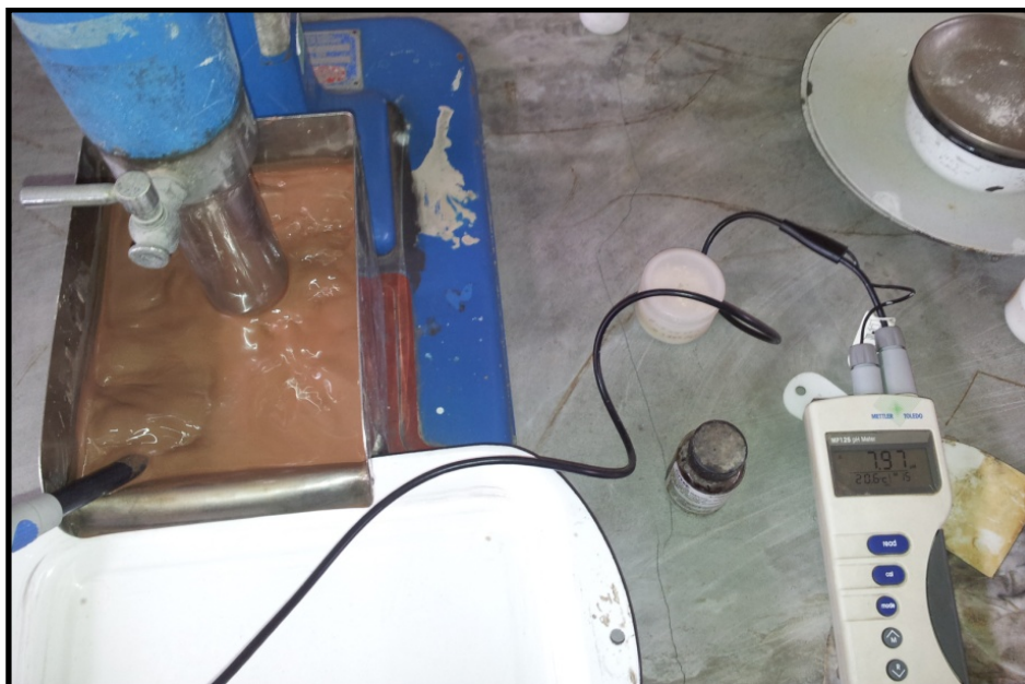
Figura 3.7.- Proceso de flotación, pH natural de 7.97
