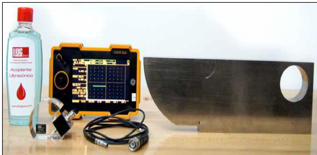
Figura 3.11: Equipo USM Go, Patrón IIW, cable coaxial, transductor y acoplante.
