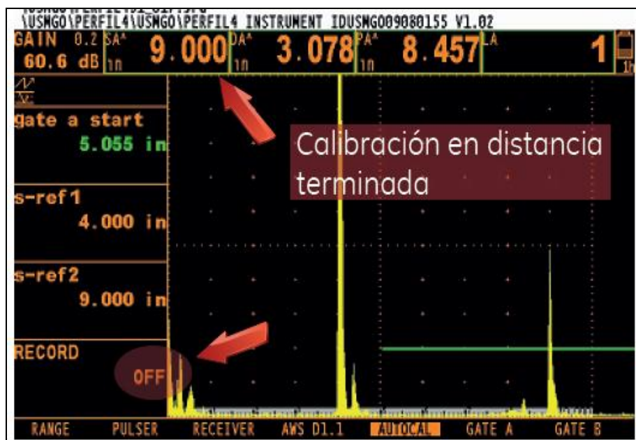
Figura 3.17: Pantalla del equipo en la calibración en distancia.
