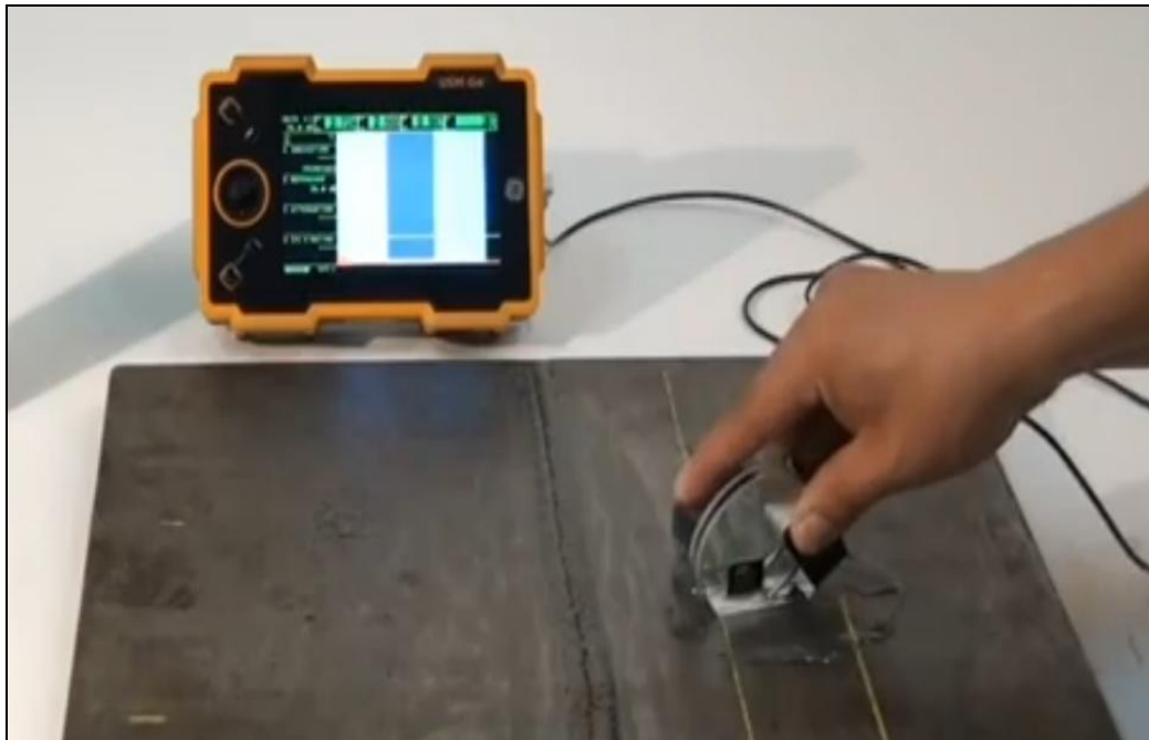
Figura 3.19: Aplicación del ensayo de ultrasonido con el equipo USM Go.
