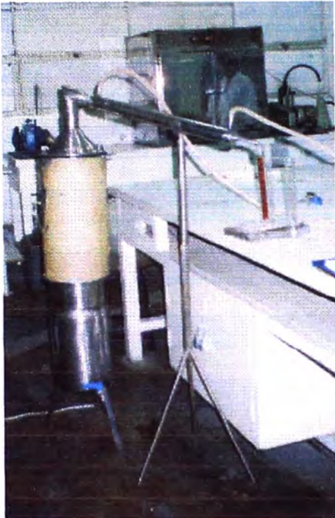
Equipo extractor de aceite esencial por arrastre de vapor
