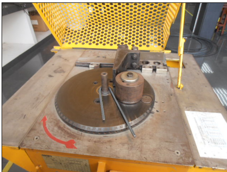
Figura 3.7: Máquina dobladora para el doblado a 180° según norma de fabricación.
