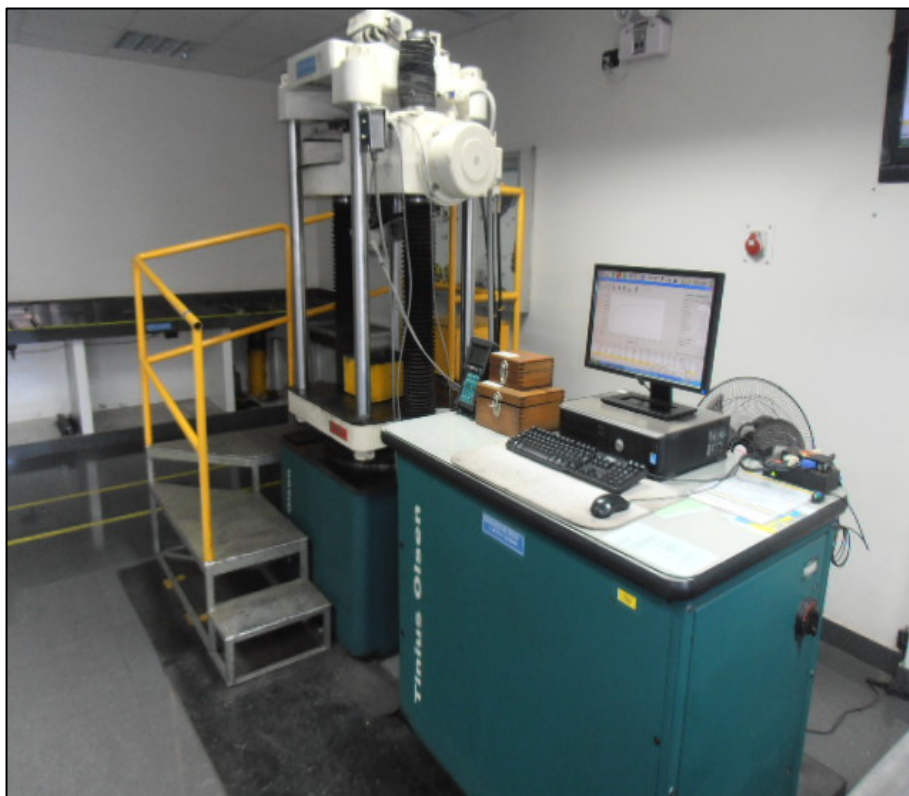
Figura 3.6: Máquina de ensayos universales Tinius Olsen, donde se realizan los ensayos de límite de fluencia, resistencia a la tracción y alargamiento.
