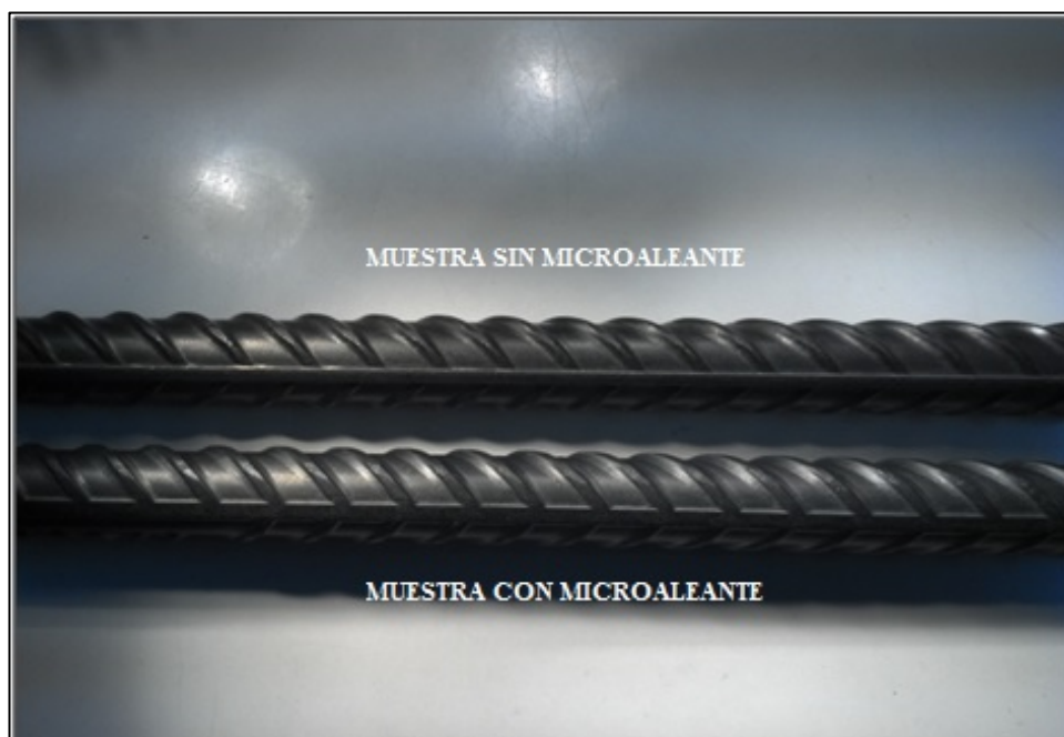
Figura 3.5: Muestras cortadas en la laminación para los ensayos mecánicos.
