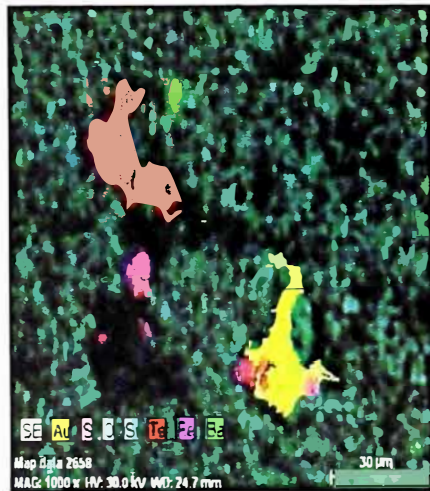
Figura 4.14 Región demarcada con las partículas de Pirita, Oro nativo, Teluro nativo y Cuarzo para el análisis elemental (a). En la imagen (b) se observa la distribución de los elementos. Las imágenes presentadas en (c) muestran el mapeo para los elementos presentes: Oro, Azufre, Oxígeno, Silicio, Teluro, Hierro y Bario en la región analizada.
