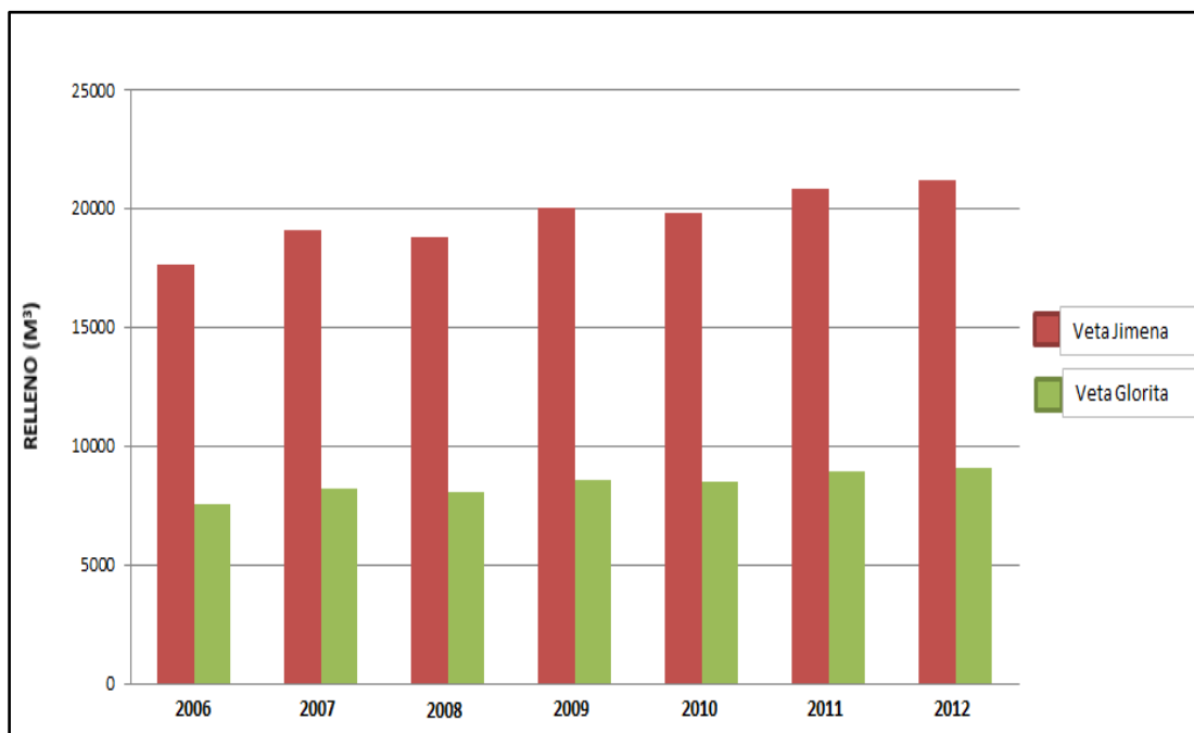
Figura 5: Evolución del relleno hidráulico en mina Papagayo.
