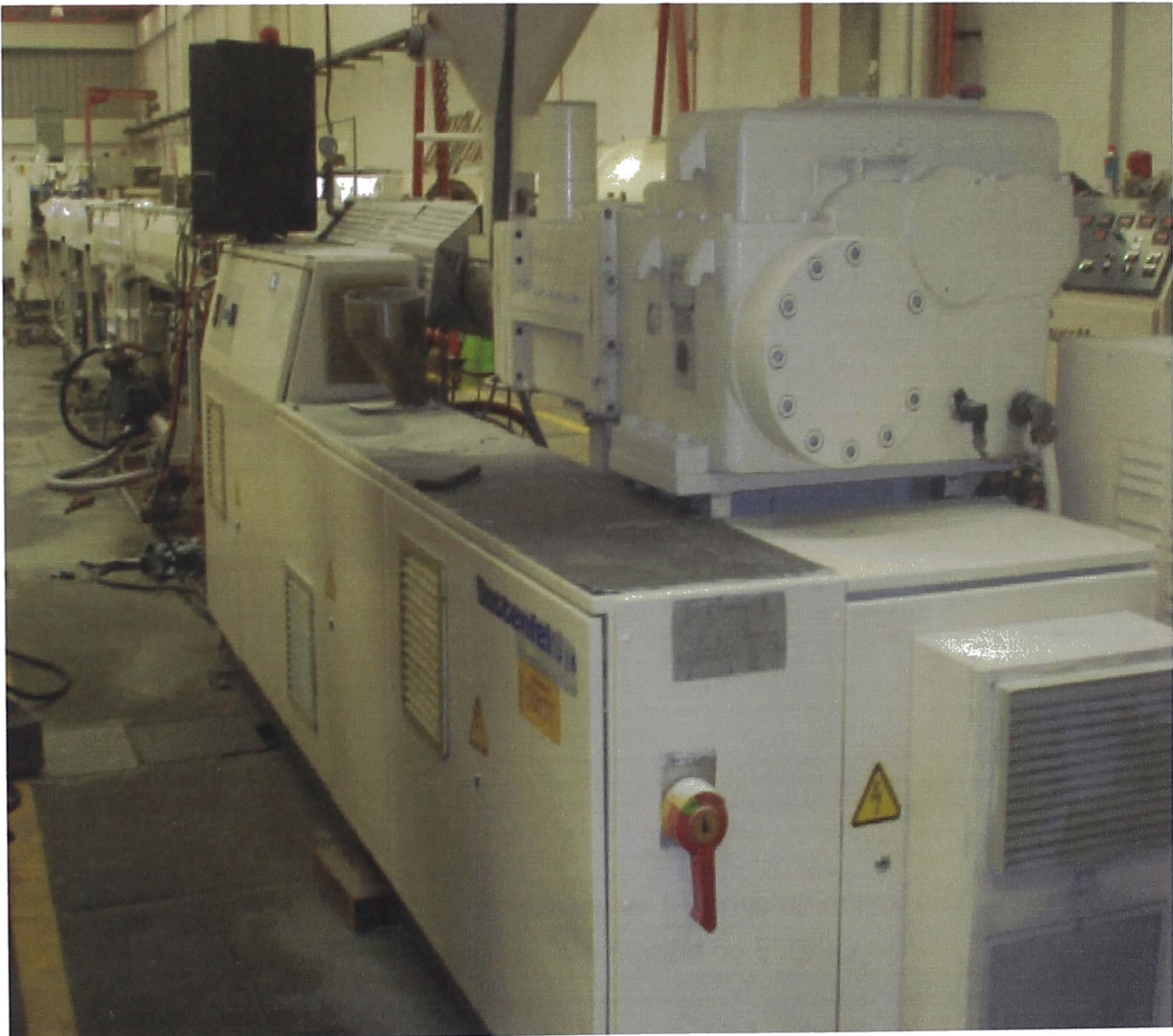
Figura: 1.1 Línea de producción completa de pequeños diámetros con extrusora de capacidad de producción de 350 Kg. / hora.
