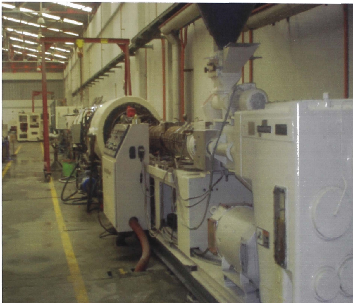
Figura: 1.2 Línea de producción completa de tuberías de mayor diámetro con extrusora de capacidad de producción de 550Kg / hora.
