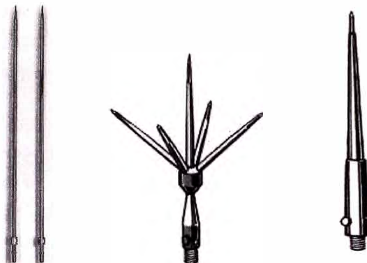
Fig. 2.16 : Terminales de Pararrayos en Instalaciones Terrestres
