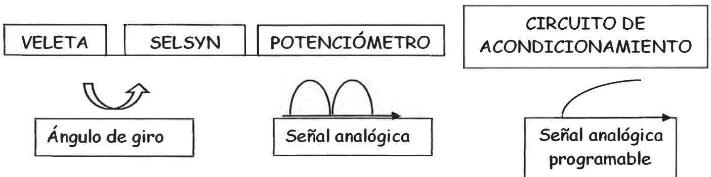
Fig. N° 4.2 Diagrama de bloques del sensor de dirección
