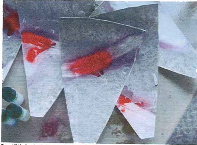
Foto N°13. Prueba de tintes penetrantes a los segmentos de Monel del Domo de la Columna.
