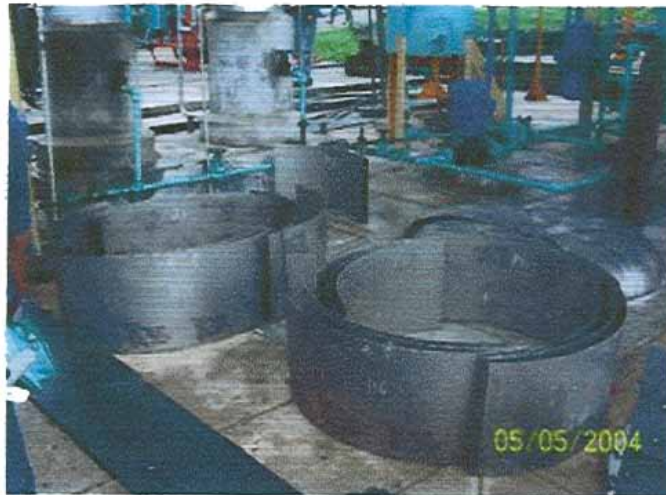
Foto N°10. Vista de las Planchas de Monel (Casquete Torisférico y Cilindro).
