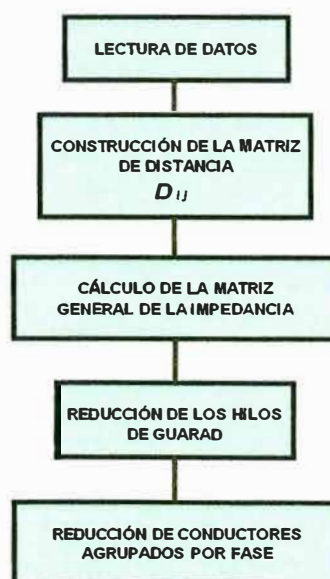
Fig. 4.5 Diagrama de bloques de un programa de computadora digital para el cálculo de impedancias serie de líneas de transmisión.
