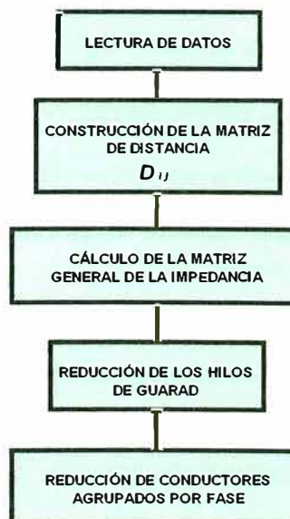
Figura 3.1 Diagrama de bloques de un programa de computadora digital para el cálculo de impedancias serie de líneas de transmisión.
