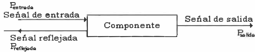
Fig. 2.2 Distribución de señales en un componentes óptico.
