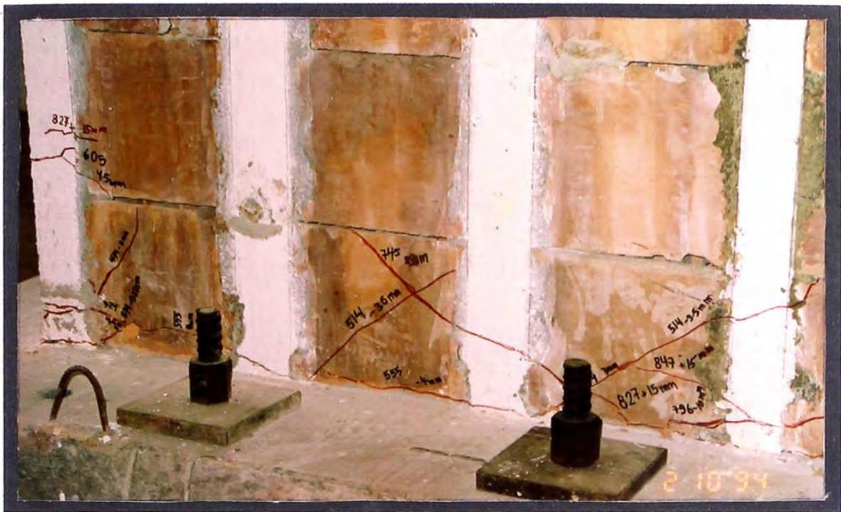
*Fisuras de tracción por corte que empiezan en el empotramiento debidas a la concentración de esfuerzos provocadas por el cambio en la geometría al pasar de la viga de anclaje a la losa aligerada..*
