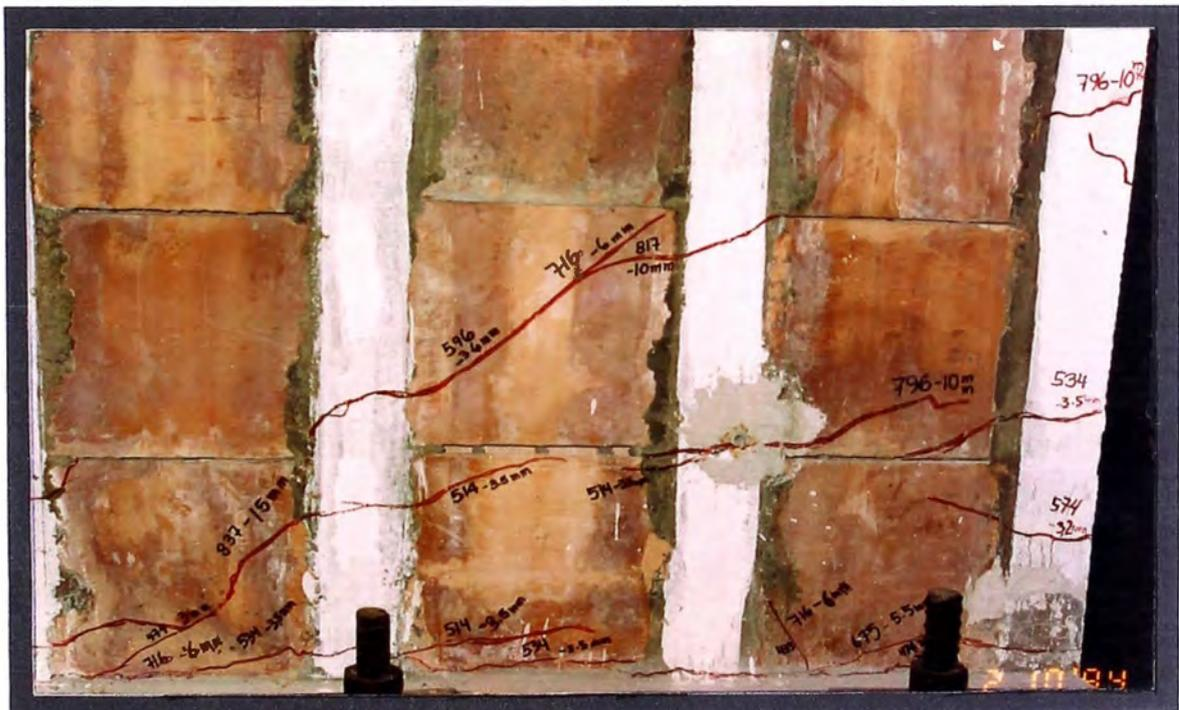
*Grietas de tracción diagonal que se propagan desde el empotramiento hasta la parte superior del espécimen, cortando viguetas y ladrillos.*
