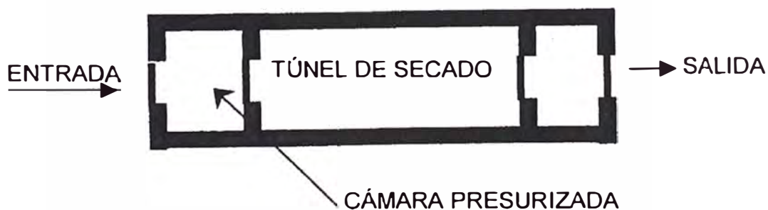
Figura nº 5.4. Ventilación artificial local
