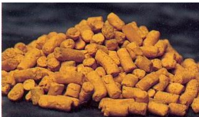
Figura N° 2.2. Pellets de Pentóxido de Vanadio.
