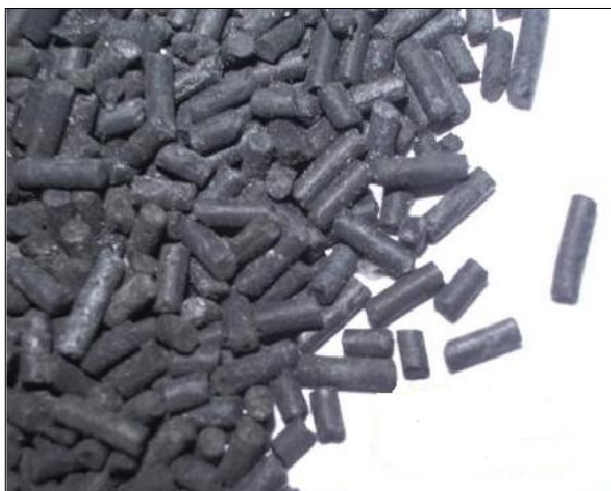
Figura N° 2.5. Pentóxido de Vanadio degradado
