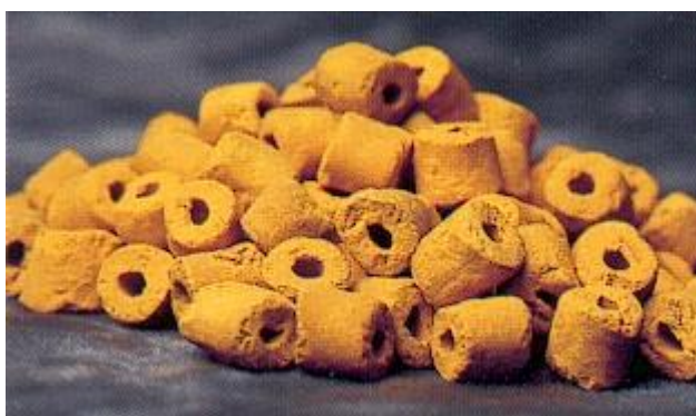
Figura N° 2.3. Anillos de Pentóxido de Vanadio.
